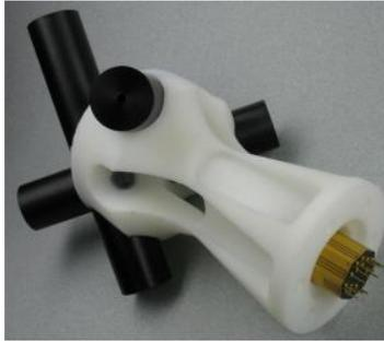
Capteur search-coil 3D avec son préamplificateur intégré dans le pied
