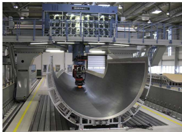
Figure 1.9 : Exemple de robot du procédé de dépose de bande automatisée par ATL [23]
