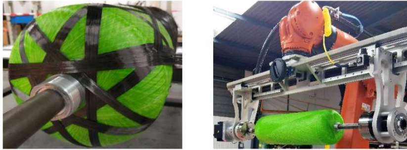
Figure 1.5 : Procédé de fabrication par enroulement filamentaire [15]
