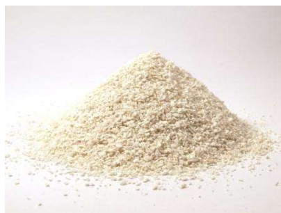
Figure 1.26 : Photos de flocons de PEKK (Kepstan® 7002PT)
