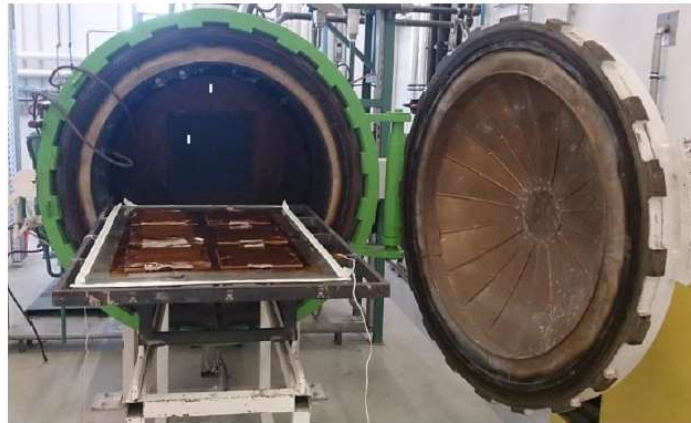
Figure 1.6 : Préparation de pièces composites pour une cuisson en autoclave [17]
