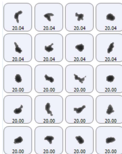
Figure 1.28 : Exemple de photos prises par Morpho-granulomètre (Morphologi G3 de Malvern ©SDTech, 2021). Reproduit avec permission
