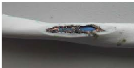
Figure 3: Défauts francs (image de gauche) et non francs (image de droite) apparaissant dans les réseaux de câblage.
