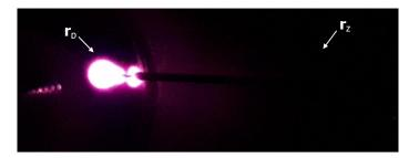
Figure 5: *Résultats expérimentaux: la méthode LCCF réussit simultanément* à activer les plasmas à  $\mathbf{r}_p$  et à empêcher leur apparition à  $\mathbf{r}_z$ .
