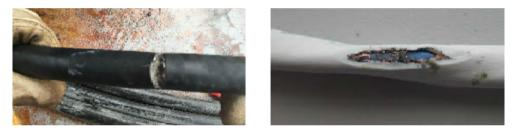
Figure 3: *Défauts francs (image de gauche) et non francs (image de droite) apparaissant dans les réseaux de câblage.*
