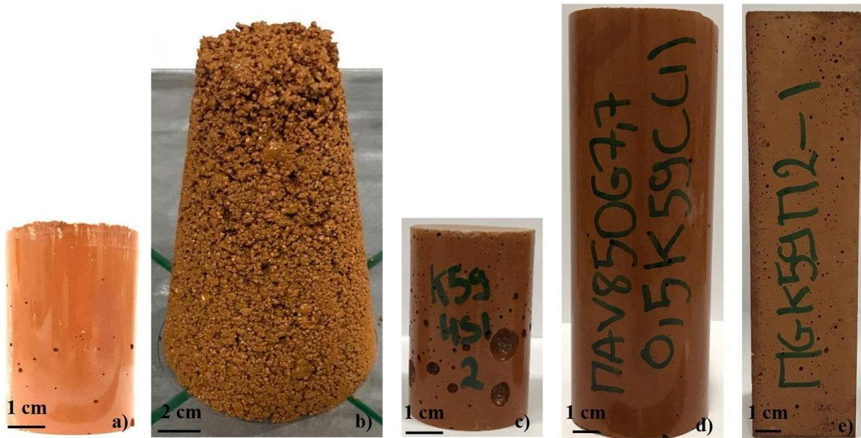
Figure V-2:Éprouvette de géopolymères fabriqués à base de PGK59. a) P2GK59 ( $\text{Ø}33 \times 50 \text{ mm}$ ) ; b) cône d'Abrams M2GK59 ; c) M2GK59 ( $\text{Ø}33 \times 50 \text{ mm}$ ) ; d) M2GK59 ( $\text{Ø}50 \times 150 \text{ mm}$ ) et e) M2GK59 ( $40 \times 40 \times 160 \text{ mm}$ ).
