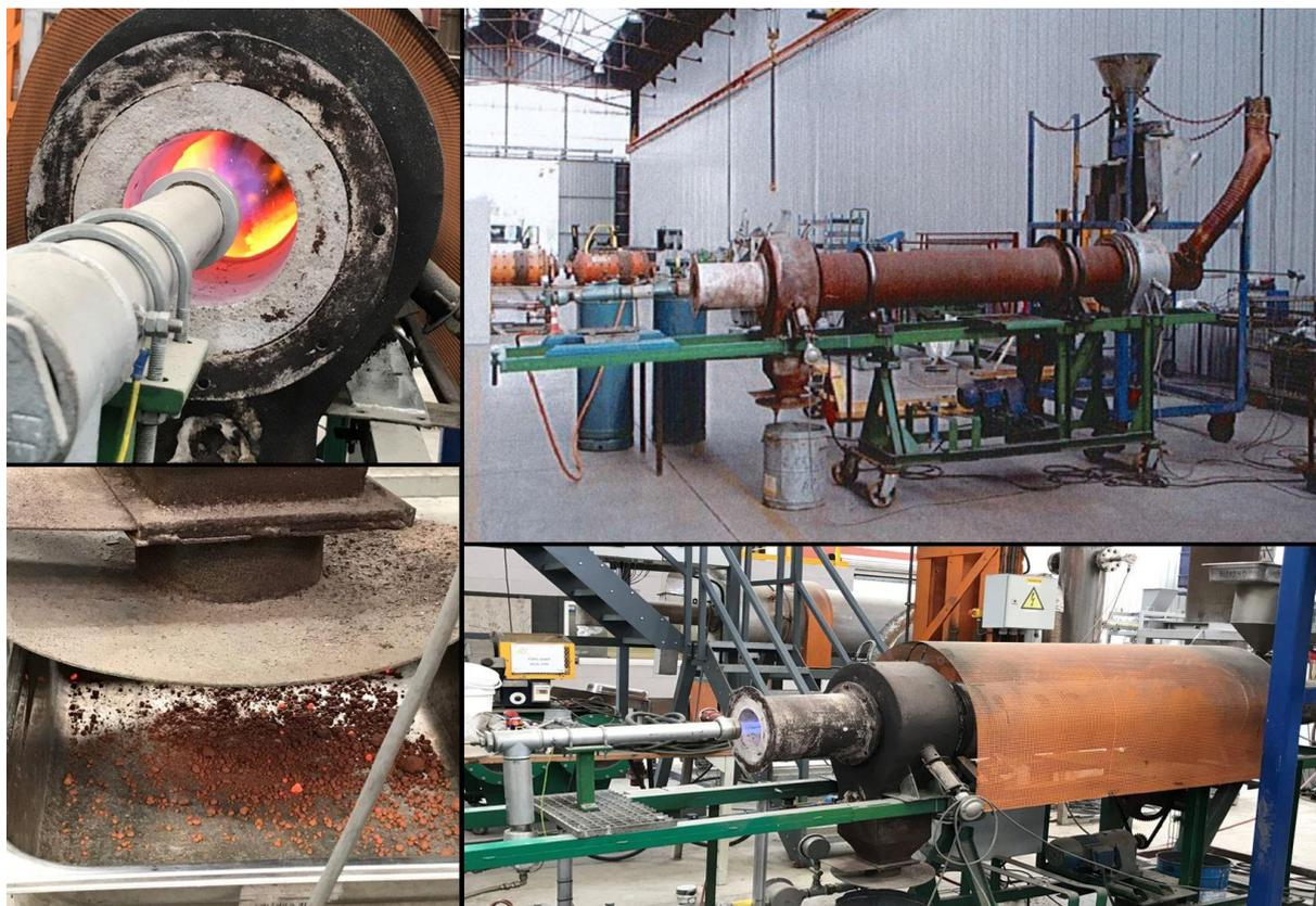
Figure V-40: Four rotatif de laboratoire utilisé pour les essais d'orientation n°2 à 4 et la calcination des 150 kg d'argile verte.
