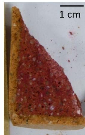
Figure II-21: Éprouvette MGN59 immergée 7 jours dans  $\text{H}_2\text{SO}_4$  (15%), testée en compression puis pulvérisée à la phénolphtaléine.
