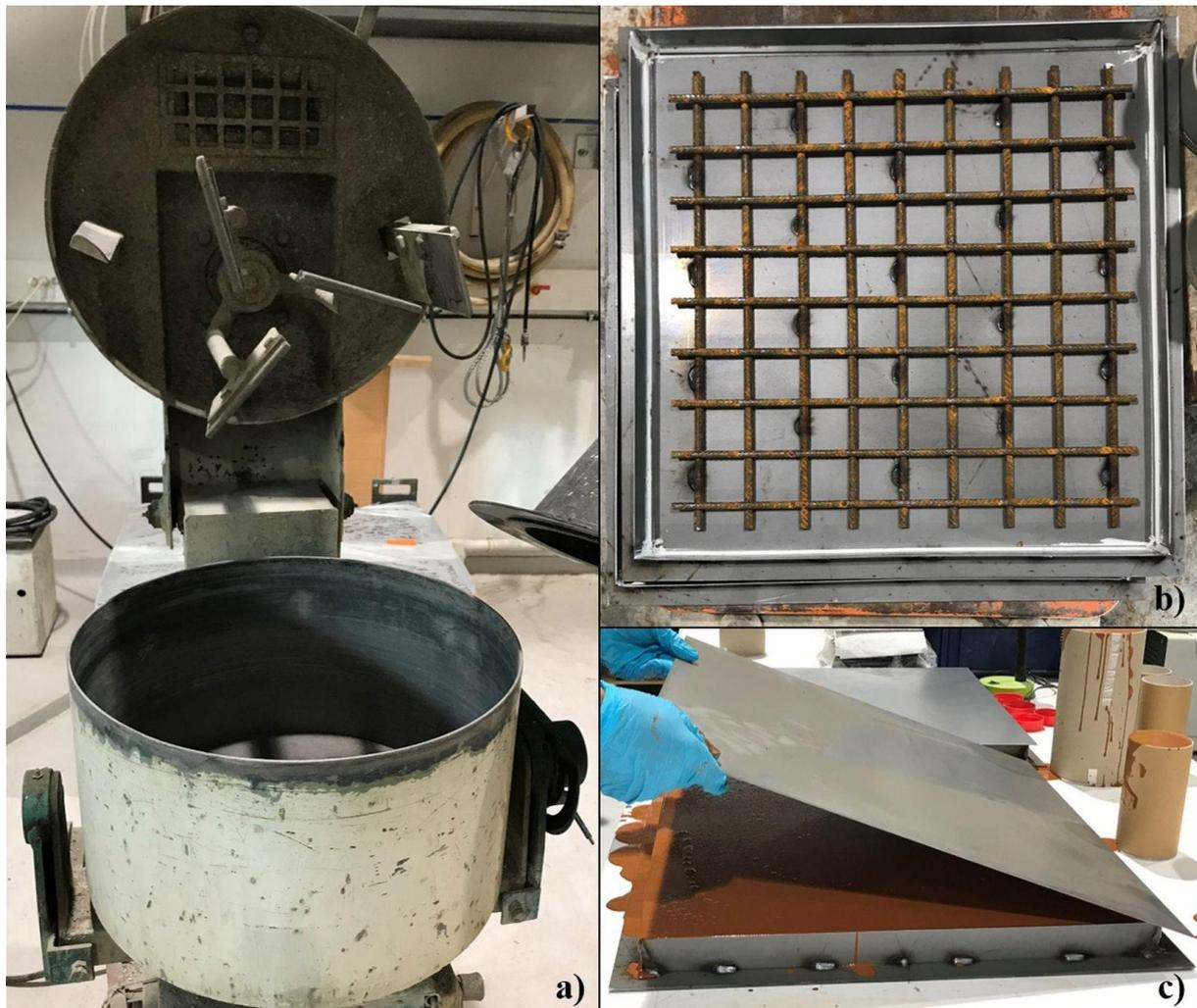
Figure V-45: a) Malaxeur utilisé pour réaliser la formulation ; b) moules (40x500x500mm) en acier contenant le treillis et photo du moule en acier rempli avec PGK59.
