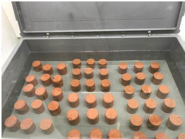
Figure II-20: Dispositif d'immersion des mortiers dans  $\text{H}_2\text{SO}_4$  (15%).
