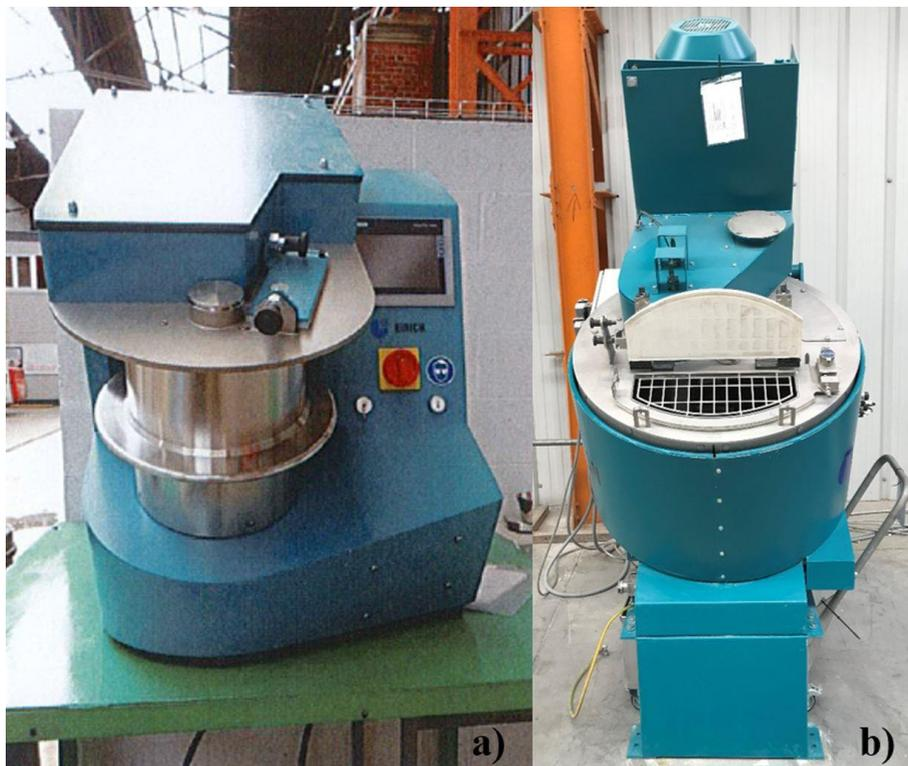
Figure V-39: Mélangeurs Eirich utilisés pour la pelletisation ; a) unité de laboratoire et b) unité pilote.
