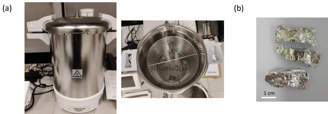
Figure II. 11. (a) Photo du modèle d'autoclave utilisé pour le THT. (b) Photo des échantillons emballés dans des feuilles d'aluminium avant le THT.
