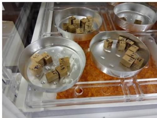
Figure II. 6. Conditionnement des échantillons de bois dans un dessiccateur avec du gel de silice (environ 2% HR).
