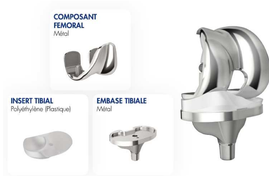
Figure 2 - Illustration des différentes parties d'une prothèse totale de genou (PTG): composant fémoral, insert et embase tibiaux (12)
