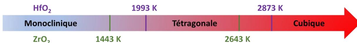
Figure 11. Transformation de phases de l'hafnie et la zircone en fonction de la température
