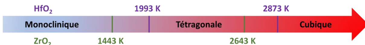
Figure 11. Transformation de phases de l'hafnie et la zirconie en fonction de la température
