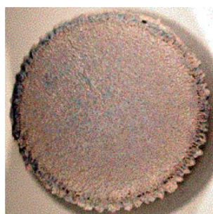
Figure 25. ZrB_2 -20 vol.% SiC -20 vol.% TaSi_2 oxydé par arc-jet à 2163 K par Opila et al. [10]
