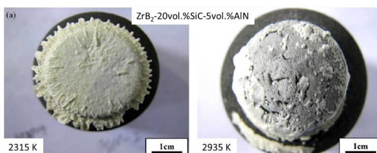
Figure 31. Échantillons de ZrB 2 -20 vol.% SiC-5 vol.% AlN après oxydation 300 s sous torche oxyacétylénique à 2315 K à gauche et à 2935 K à droite [64]
