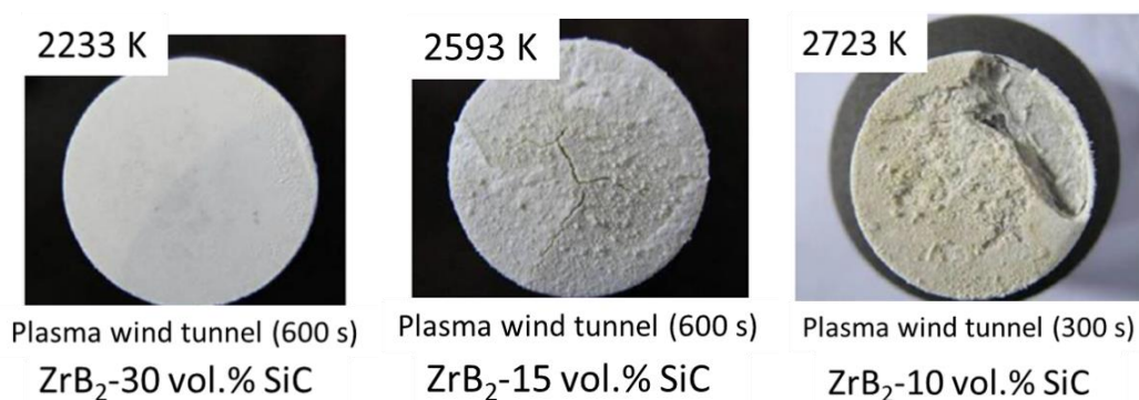
Figure 15. Photos des échantillons oxydés dans un tunnel aérodynamique à plasma pendant 300 ou 600 s entre 2233 et 2723 K [40]
