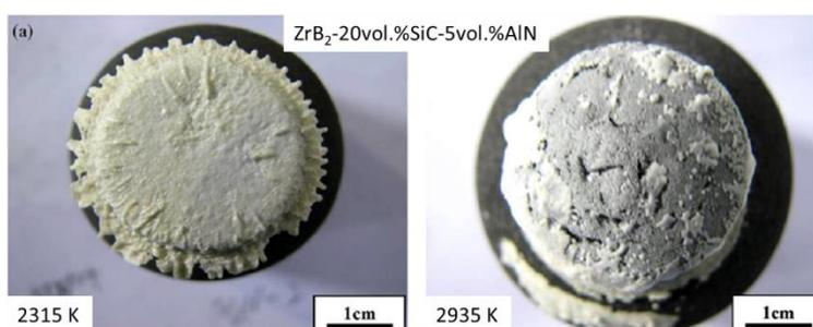
**Figure 31.** Échantillons de ZrB<sub>2</sub>-20 vol.% SiC-5 vol.% AlN après oxydation 300 s sous torche oxyacétylénique à 2315 K à gauche et à 2935 K à droite [64]
