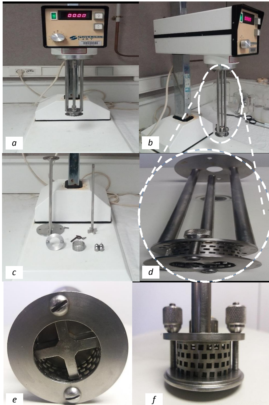
Figure 6 — (a et b) images du dispositif mixeur Silverson L4RT.(c) les accessoires, (d) le bras, (e) croisillon qui tourne à vitesse contrôlée et (f) le grillage cylindrique.
