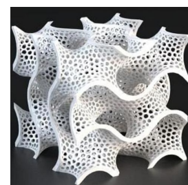
(l) Gyroid en polymère obtenu par fabrication additive (shapeways™)
