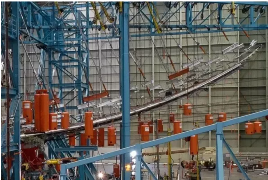
FIGURE 1.23: Palonnier utilisé en aéronautique pour appliquer des chargements répartis sur une aile d'avion
