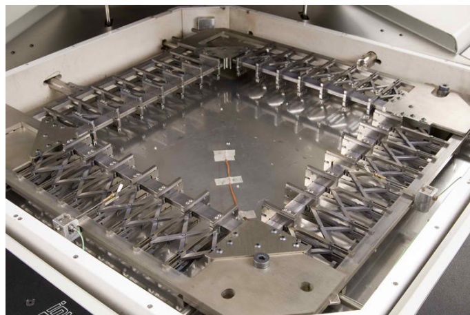
FIGURE 1.25: Essai de bi-extension de films polymères par Accupull (entreprise kairo)
