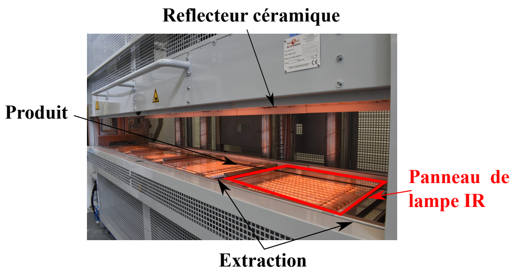
Figure 1.1 – Vue globale du four IR de la ligne d'imprégnation (IRT-SE) en position ouverte
