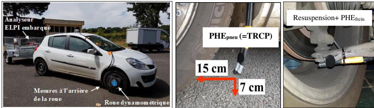
Figure 12 : Mesures embarquées des émissions de PHE pneu (mesurées derrière le pneu avant droit, photo au milieu, et dans le creux du pneu, photo à droite) au moyen du véhicule instrumenté du centre Ifsttar de Nantes et des analyseurs de particules embarqués dans une remorque attachée au véhicule
