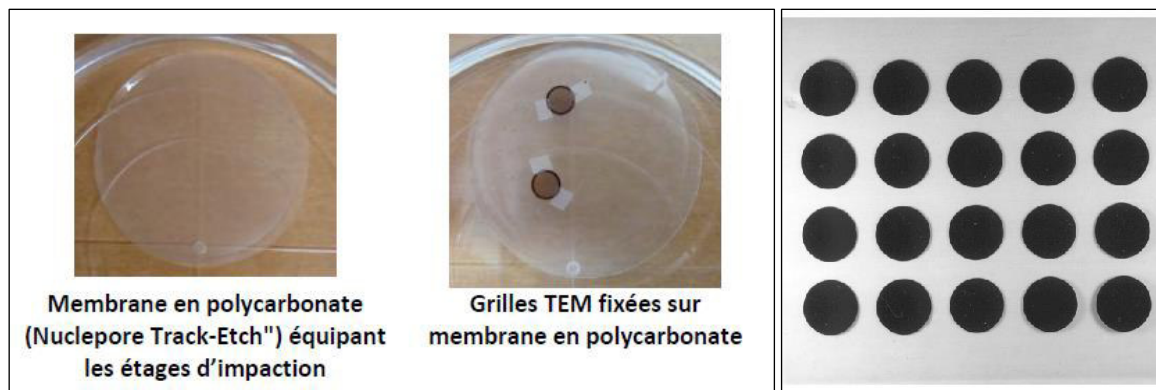
Figure 21 : Les supports de collecte utilisés: les membranes en polycarbonate et des grilles TEM fixées au-dessus (à gauche), et les pastilles adhésives en carbone (à droite)
