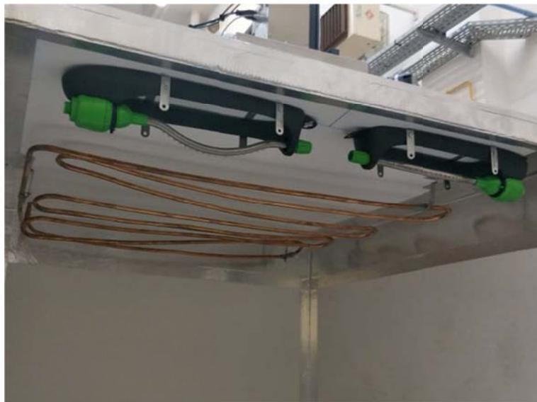
Figure V- 5 : L'installation de simulateur de pluie
