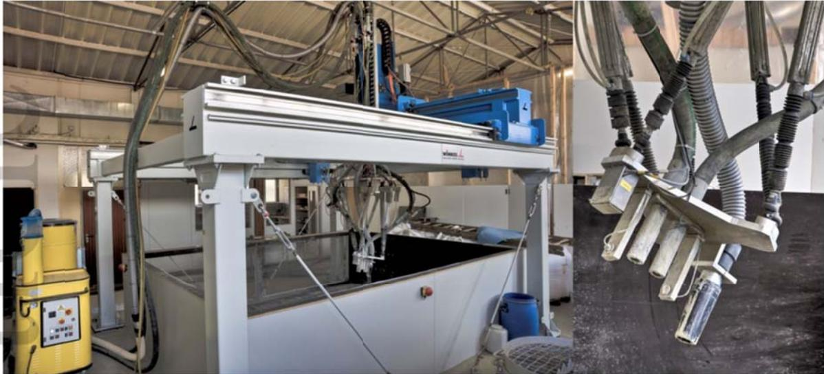
Figure I- 8 : Production automatisée d'éléments en béton fonctionnellement gradués ; Photo crédit : ILEK/ISYS/IWB, Université de Stuttgart
