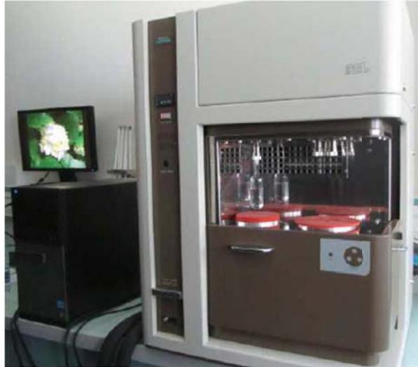
Figure III-19 : Dispositif volumétrique de mesure des isothermes de sorption : Belsorp-aqua3
