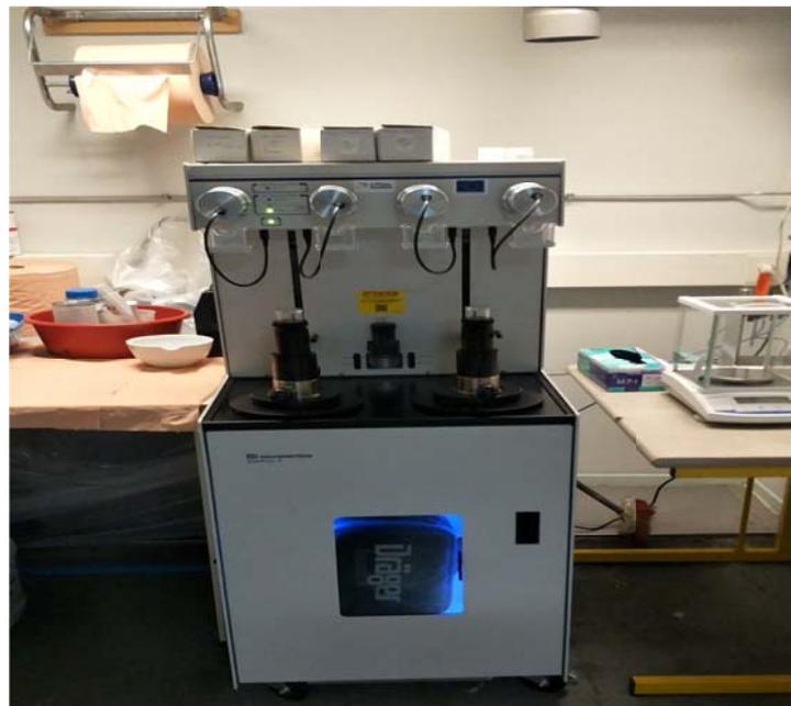
Figure III-11 : Porosimètre à mercure Micrometrics®-Autopore V 9600
