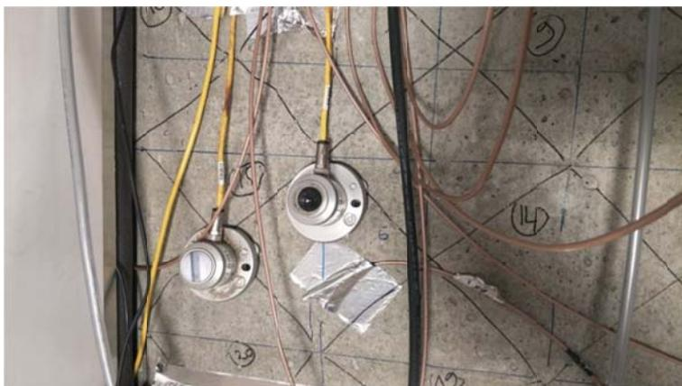
Figure V- 7 : La disposition des capteurs d'éclairage CLO & GLO (Pyranomètre et Pyrgéomètre)
