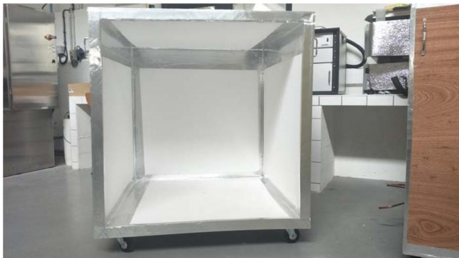
Figure V- 2 : Le caisson construit de 1,20m x 1,20m x 1 ,20m
