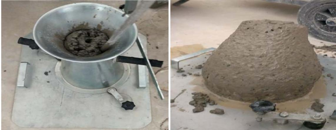
Figure IV- 4: Essai de l'ouvrabilité (Essai de cône d'Abrams)
