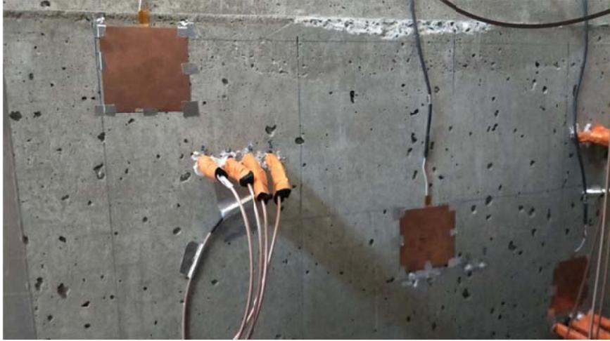
Figure V- 11 : La disposition des capteurs T&HR et Capteurs de flux thermique
