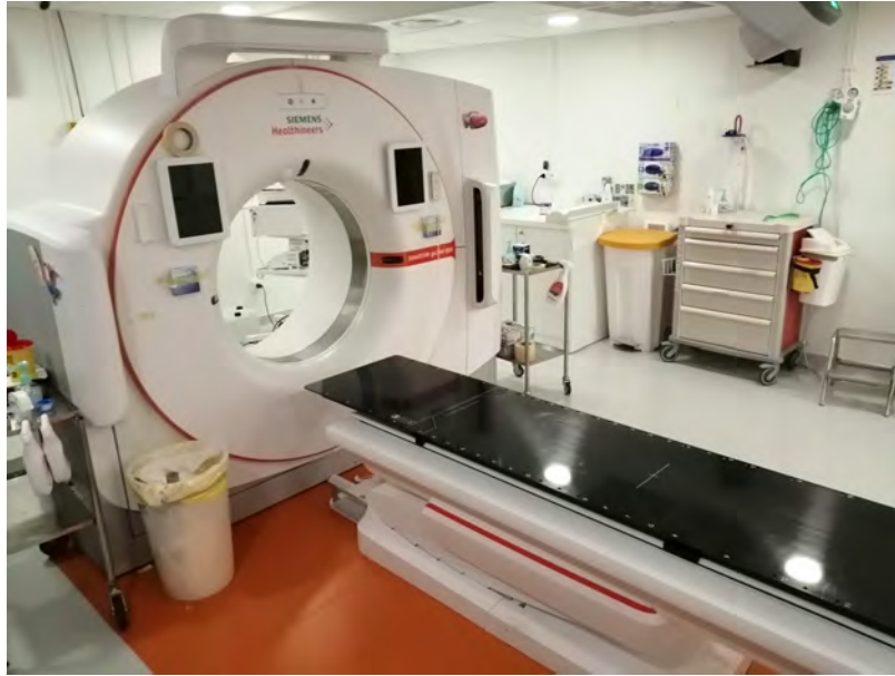
FIGURE 1.1 – Exemple de tomodensitomètre SOMATOM go.Sim de marque Siemens Healthcare au Centre Léon Bérard à Lyon. Le patient est allongé sur le lit, lequel coulisse à l'intérieur de l'anneau. Dans l'anneau, une source de rayons X est placée d'un côté, et un détecteur de l'autre. Ces deux éléments entrent en rotation autour du patient pour permettre l'acquisition.
