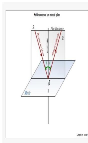
Pour aller d'un point B à un point A, la lumière reprendra exactement le même chemin que celui emprunté pour aller de A à B. Il s'agit du principe de retour inverse de la lumière. « Pour qu'il y ait une optique possible, il faut qu'il y ait la possibilité de représentation à un point donné dans l'espace réel de tout point donné dans l'espace réel. À ce point peut correspondre un point, un seul, dans un autre espace qui est l'espace de l'imaginaire. Ceci est l'hypothèse
