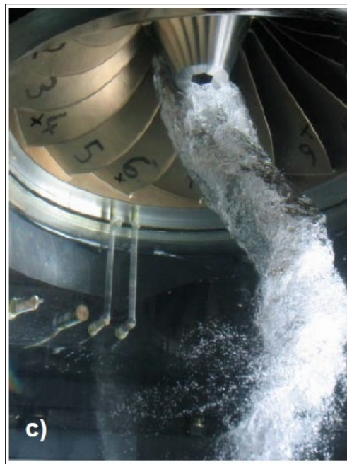
Figure 1.4 Exemple d'observation de torche dans l'aspirateur Tirée de Seidel et al. (2014)
