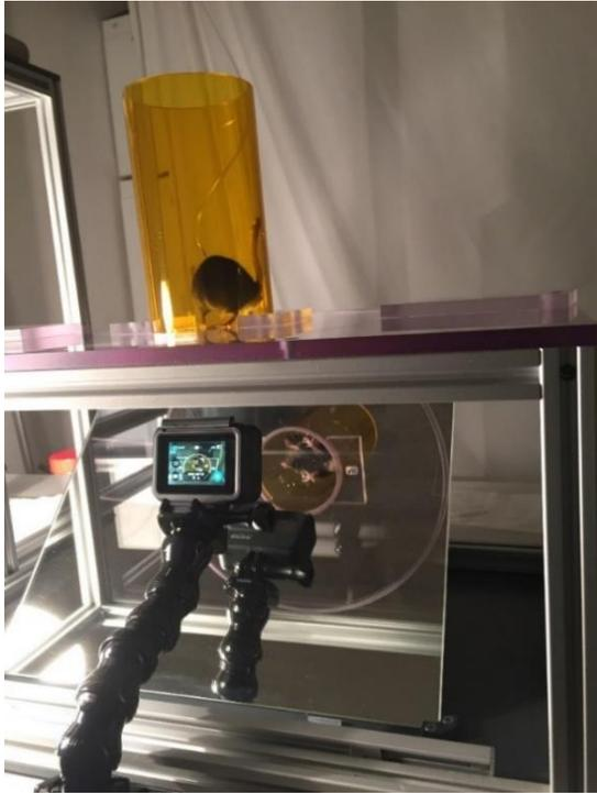
**Fig 5** : Dispositif de mesure de la réactivité orofaciale comportant un cylindre en plexiglas où les souris sont placées, un miroir reflétant les mimiques orofaciales, une caméra permettant de filmer la réactivité et une pompe permettant l'injection des solutions expérimentales par liaison du cathéter de la pompe au connecteur de la canule intraorale.
