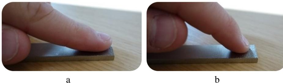
Figure 4.11 – Illustration d'une variation de l'angle de contact entre le doigt et l'échantillon : (a) Angle de  $30^\circ$ ; (b) Angle de  $60^\circ$
