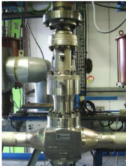
Figure 1.1 : Robinet à soupape employé dans les centrales nucléaires permettant la régulation de l'eau du circuit de refroidissement (circuit primaire) [40].
