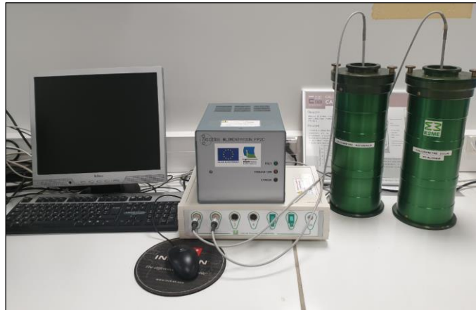
Figure 36 : Semi-adiabatic calorimeter (NF EN 196-9)
