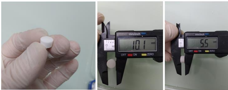
Figure 209 : Photographies et dimensions d'une pastille produite pour les évaluations biologiques.
