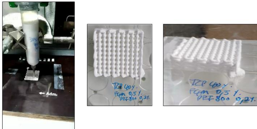
Figure 163 : Impression et pièces imprimées de macroporeux de \beta -TCP non dopé à partir d'une pâte contenant 0,5% massique en HPMC.
