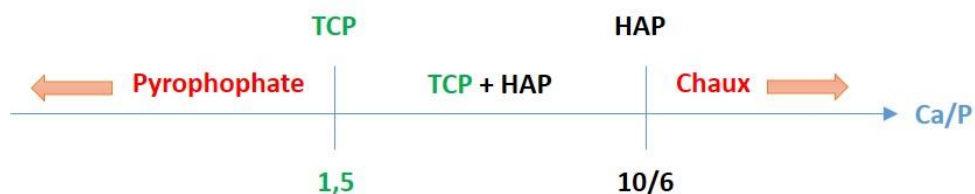
Figure 7 : Produits formés lors de la synthèse par co-précipitation du TCP en fonction du rapport Ca/P. Adapté de [Cham18].
