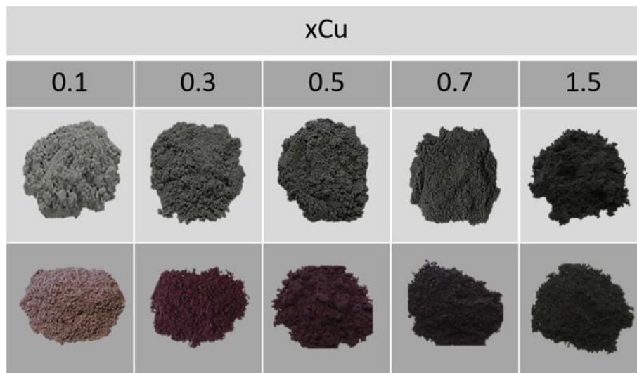
Figure 118 : Photographies de poudres de \text{CuHA}_x (avec x variant de 0,1 à 1,5) issues de [BMMC21]. Les mélanges initiaux de poudres HA et \text{CuO} sont en haut et les poudres de \text{CuHA}_x obtenues après broyage de pastilles frittées à 1100 °C pendant 1 h sont en bas. Les colorations obtenues sont proches des teintes observées pour les pastilles frittées de Mg-Sr-Cu (2,0-2,0-0,2 mol%) et de 2,25 mol% Cu-TCP.
