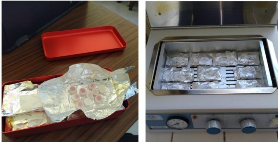
Figure 212 : Photographies des étapes de stérilisation des pastilles, avec l'emballage dans le papier aluminium et le traitement thermique dans le stérilisateur de laboratoire.
