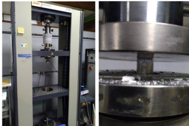
Figure 202 : Photographies de la machine d'essai universelle Zwick Z100 équipée d'une cellule de charge calibrée d'une capacité de 100 kN lors d'un essai de compression avec un échantillon.
