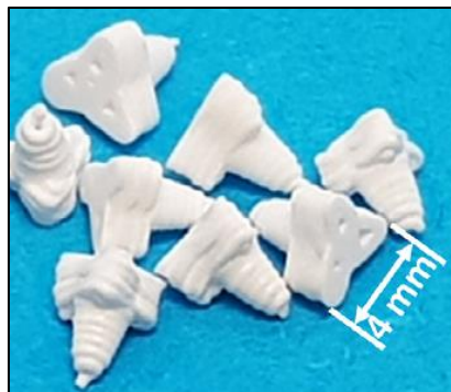
Figure 32 : Granule de BCP imprimée par robocasting. Issus de [HSEG19].
