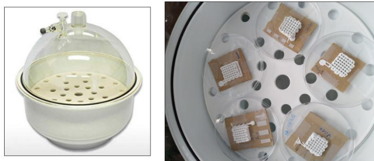
Figure 165 : Dispositif de séchage sous atmosphère contrôlée au sein d'un dessiccateur rempli d'eau.
