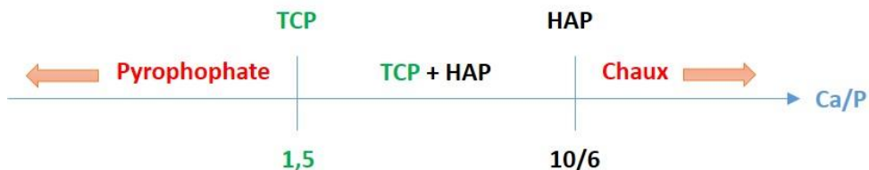
Figure 7 : Produits formés lors de la synthèse par co-précipitation du TCP en fonction du rapport Ca/P. Adapté de [Cham18].
