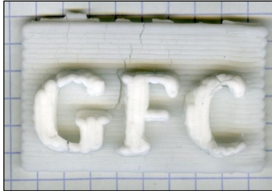
Figure 187 : Photographie du logo imprimé, séché et fritté trois heures à 1100 °C (diamètre de buse de 1,2 mm) du Groupement Français de la Céramique (GFC) à partir de la pâte de référence.
