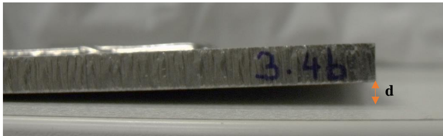
Figure 4.20 Déplacement du substrat observé sur une pièce après le la fabrication d'un cordon
