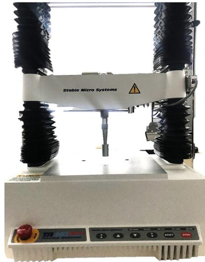
FIGURE 2.7: Photo de l'analyseur de texture TA.HD.Plus.
