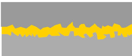
FIGURE 1.22: Représentation de la lubrification hydrodynamique.
