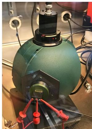
Figure II.29 : Photographie du montage de mesure EQE
