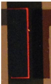
Figure V.16 : Photographie de l'OLET avec DCM en fonctionnement
