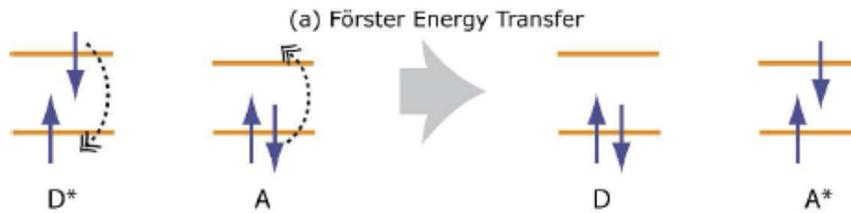
Figure 1-11 : Schéma simplifié du mécanisme de transfert Förster [32]
