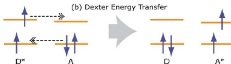
Figure I.12 : Schéma simplifié du mécanisme de transfert Dexter [32]
