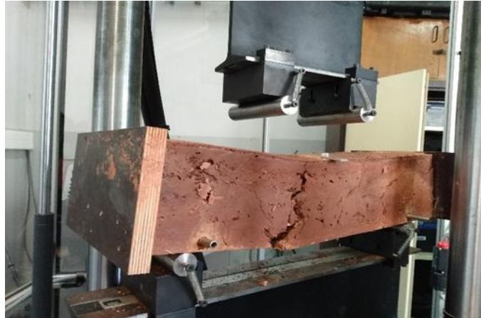
Figure IV.23: Mode de rupture des poutres de béton de terre avec armatures en pin lisses bloquées aux extrémités
