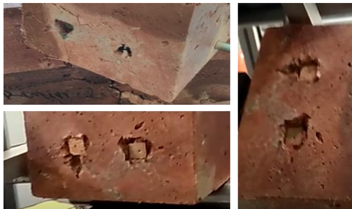
Figure IV.21: Glissement des armatures
