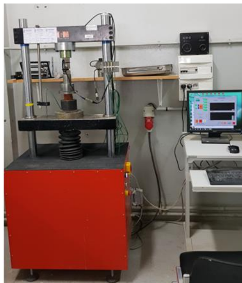
Figure III.3: Essai de compression sur les éprouvettes cylindriques
