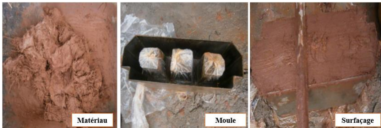
Figure III.15: Le moulage des entrevous
