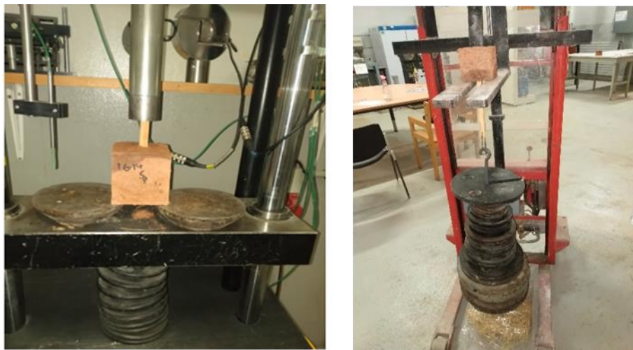
Figure IV.11 : Essais d'adhérence en compression (droite) ou en traction (gauche)
