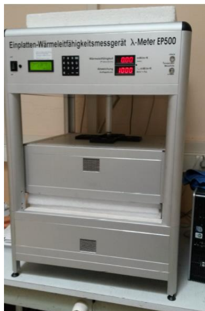
Figure II.9: Appareil de mesure de la conductivité thermique \lambda -Meter EP-500
