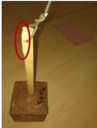
1Figure IV.15: Extrémité de l'armature en pin fendu durant l'essai d'adhérence
