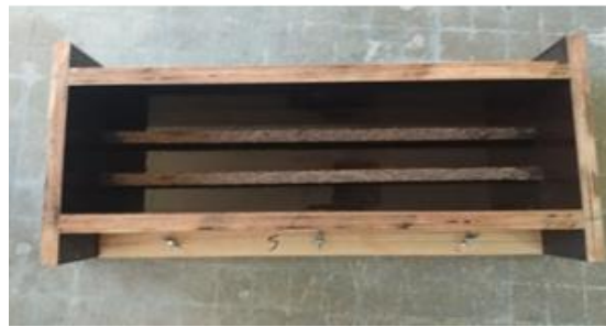
Figure IV.9: Préparation des moules des poutres en béton de terre armé de bois
