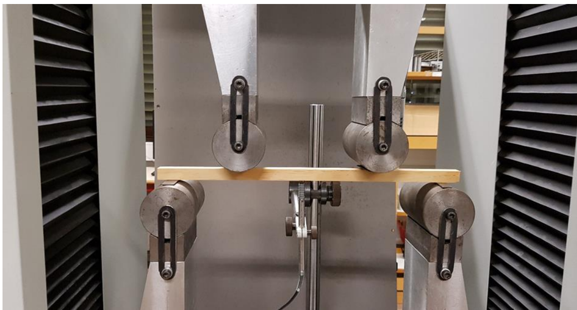
Figure II.13: Essai de flexion 4 points sur éprouvettes de pin
