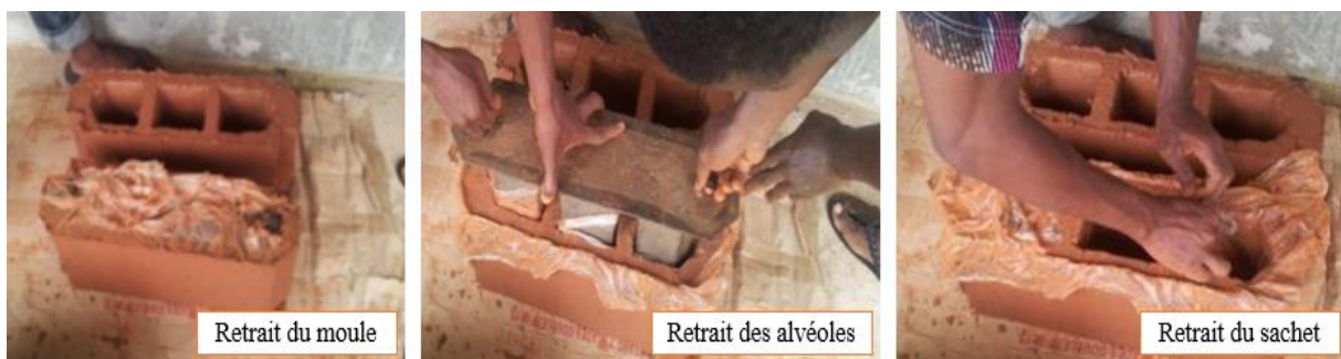
Figure III.16: Le démoulage des entrevous
