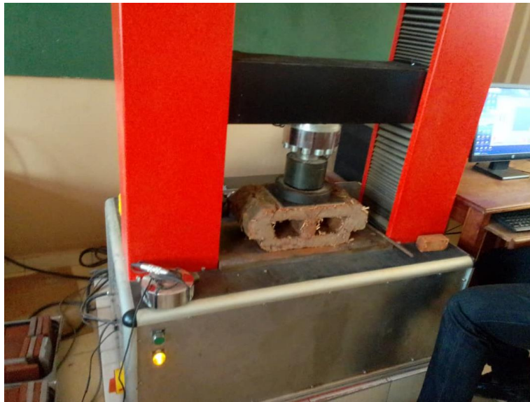
Figure III.23: Essai de compression longitudinale sur entrevous
