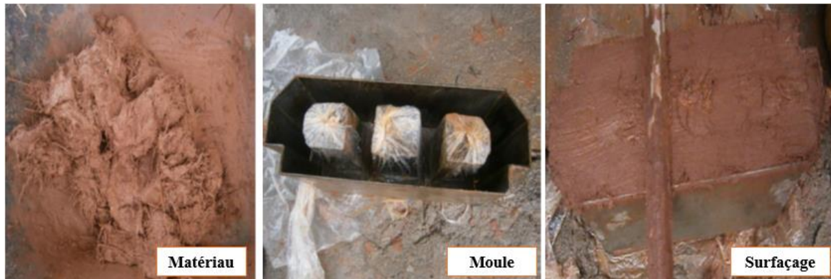
Figure III.15: Le moulage des entrevous
