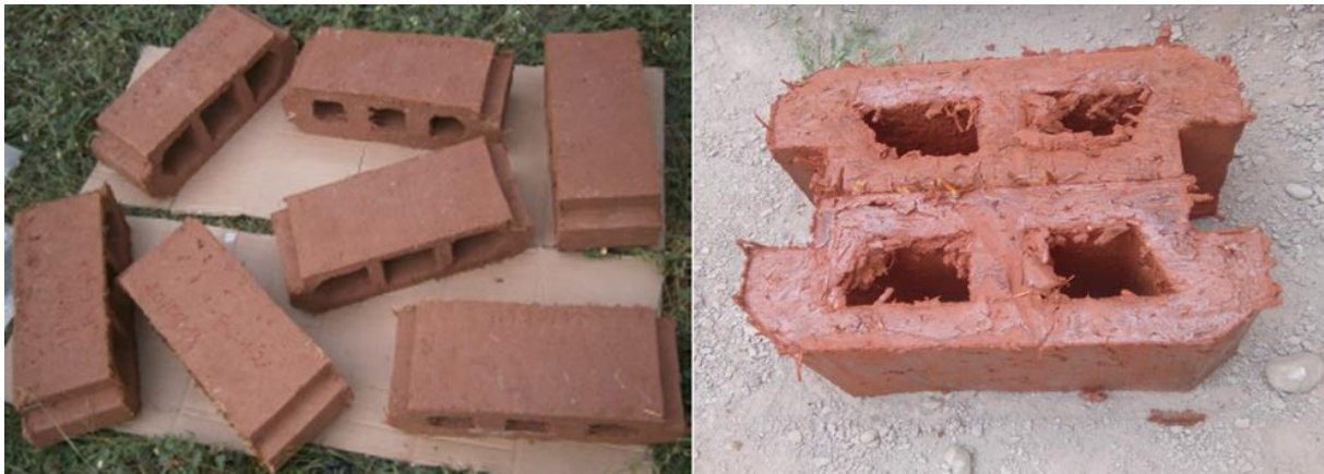
Figure III.17: Le séchage des entrevous
