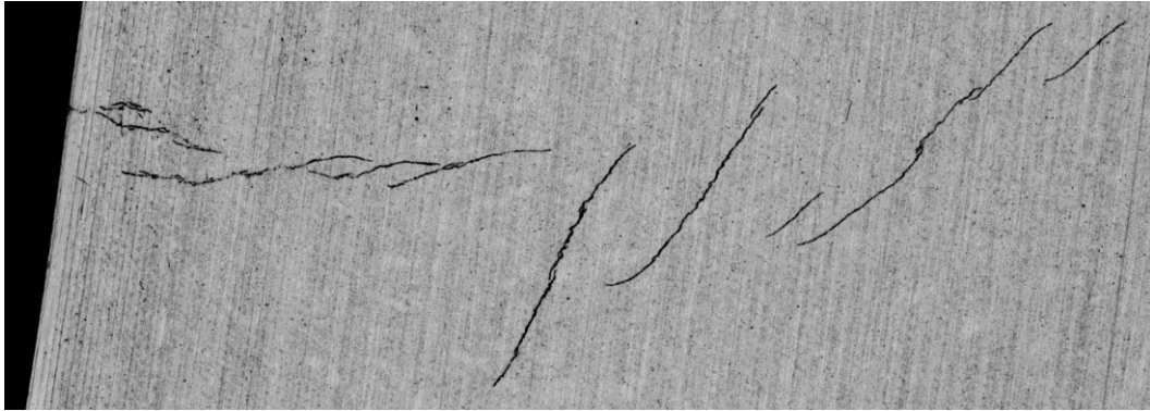
Figure 56 : Imagerie par ultrasons Hautes fréquences (75 MHz) de la même fissure débouchante que présenté sur les figures 34 et 35.
