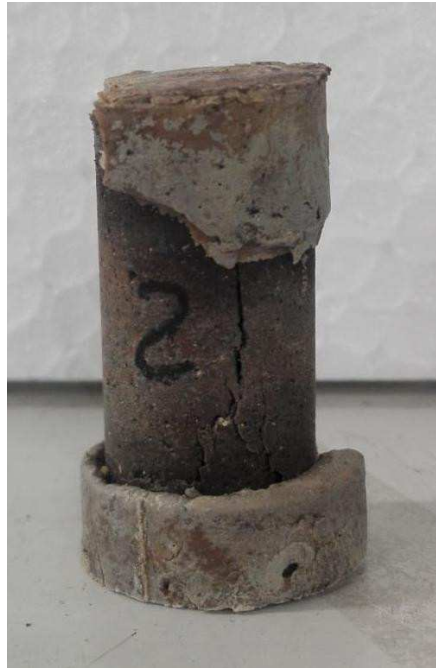
FIGURE 4.5 – Éprouvette de compression du coulis de ciment utilisé pour remplir les inclusions (vue après rupture).
