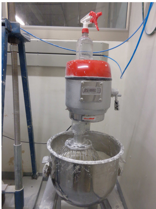
(a) Malaxeur et pulvérisateur permettant de mélanger le kaolin et l'eau afin d'obtenir la teneur en eau souhaitée.
