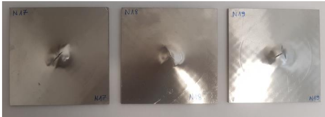
Figure 3.26 Eprouvettes d'hybrides Nat-CS-2/1-0,2 après impact
