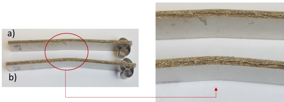
Figure 3.6 Faciès de rupture des éprouvettes de flexion : a) UD-CS-2/1-0,2 (SF), b) UD-CS-2/1-0,2 (AF)
