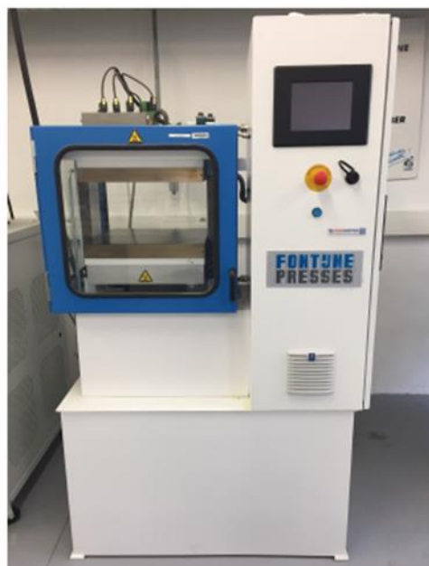
Figure 2.4 Photo de la presse de thermocompression Fontijne Grotnes TPC 321 utilisée pour fabriquer les plaques composites et hybrides
