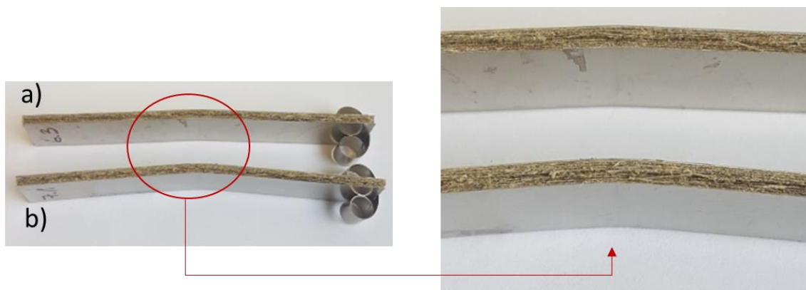
Figure 3.6 Faciès de rupture des éprouvettes de flexion : a) UD-CS-2/1-0,2 (SF), b) UD-CS-2/1-0,2 (AF)
