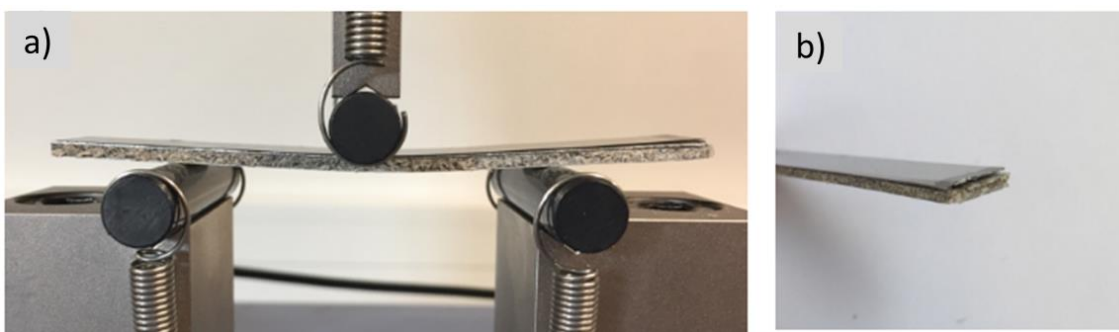
Figure 3.13 Rupture de l'hybride UD-CS-2/1-0,3 lors de l'essai de flexion : a) après la rupture, b) zone de rupture.
