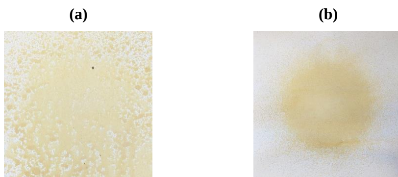
Figure 28 : revêtement SM1_{100} appliqué avec une pression de (a) 1 et (b) 4 Bars.
