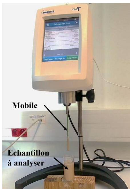
Figure 14 : photo du viscosimètre utilisé avec les différents composants.
