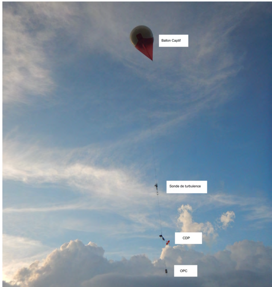
FIGURE 5.16 – Photographie du ballon captif avec une sonde de turbulence, un CDP et un OPC attaché à son câble.
