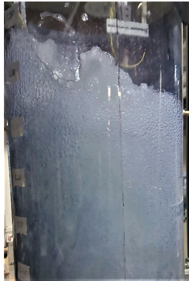
Figure 4.2 – Surface libre agitée sous l’effet du gaz injecté à haut débit. La photo a été prise en régime hétérogène à v_{sg} = 22,75 cm/s. On constate la présence d’une couche bulleuse plus ou moins épaisse au niveau de la surface libre.
