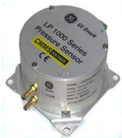
Figure 2.4 – Capteurs de pressions utilisés lors des essais. Le capteur GE Druck LP1000 est représenté à gauche. Le capteur Rosemount 2051 CD21 est représenté à droite.
