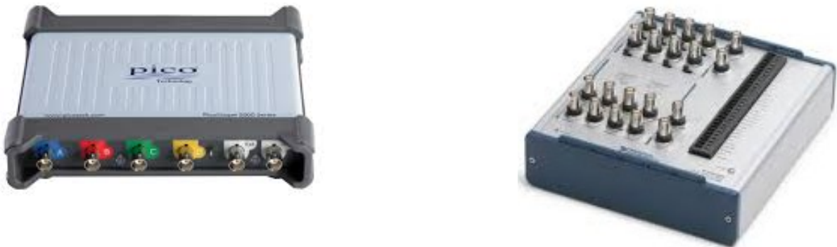
Figure 2.5 – Gauche: Photo d'un Picoscope 5443A. Droite: Photo d'une carte d'acquisition NI-6356.
