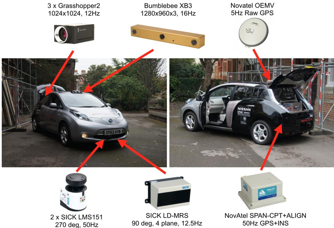
FIGURE 3.14 – Capteurs utilisés pour collecter l'ensemble des données Oxford RobotCar [65].
