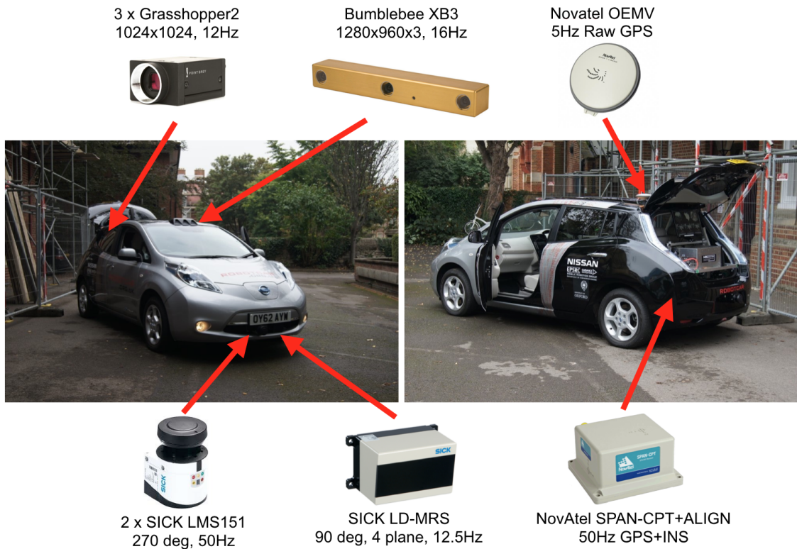
FIGURE 3.14 – Capteurs utilisés pour collecter l'ensemble des données Oxford RobotCar [65].
