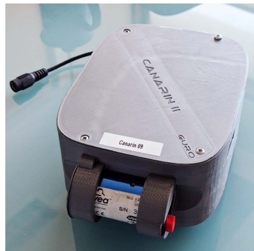
FIGURE 7 : CANARIN II avec un capteur Cairsens NO 2
