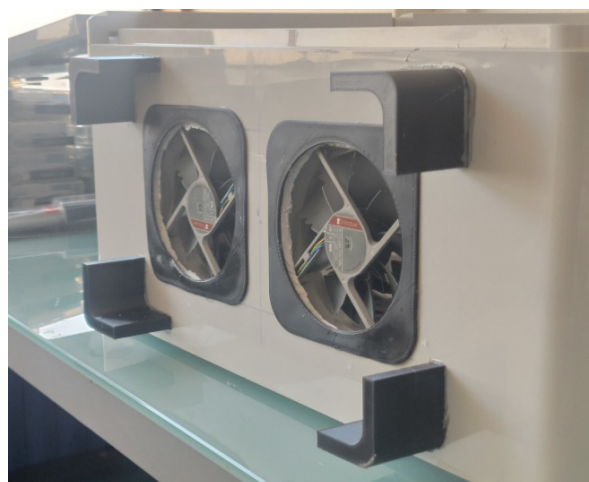
FIGURE 26 : Pieds permettant l'extraction d'air
