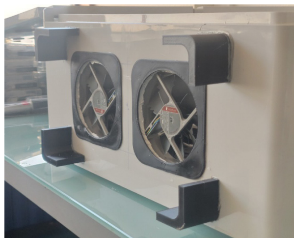
FIGURE 26 : Pieds permettant l'extraction d'air
