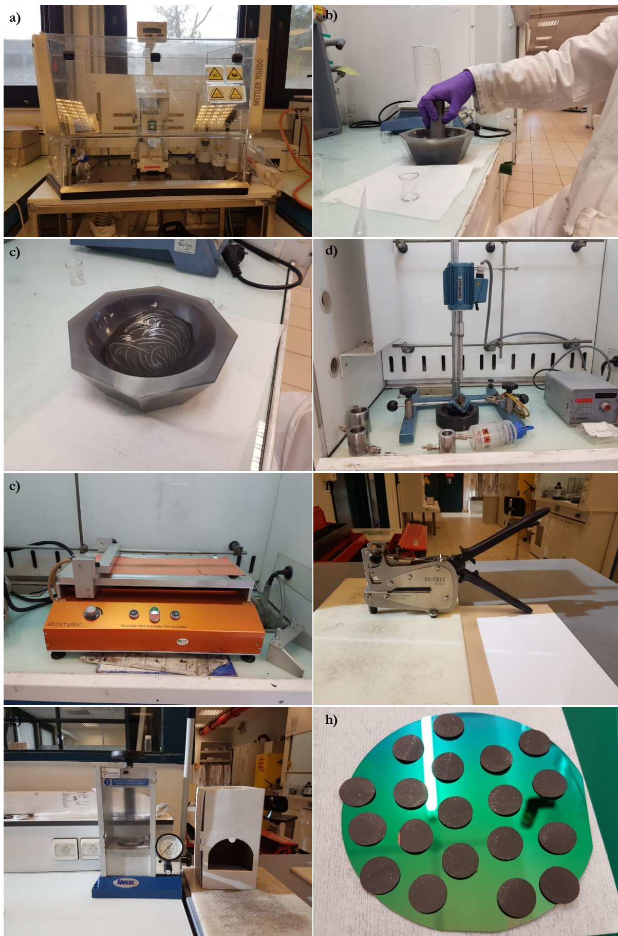
Figure III.C.9 Réalisation d'une électrode composite particules/nanofils par formulation d'encre a), b), c) et d), enduction sur cuivre e), f), g),h).
