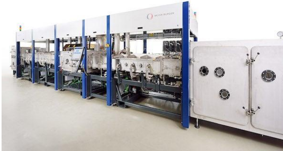
Figure IV.A.23 Photographie de la chaîne de production continue sur tapis roulant d'électrode de nanofil de silicium pour anode de batteries lithium par la start-up Amprius .
