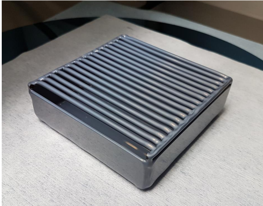
Figure II.C.7 Aperçu en contre plongée du « panier à wafer CVD », module pour le réacteur EasyTube 3000 first Nano en vue de production de masses importantes de nanofils.
