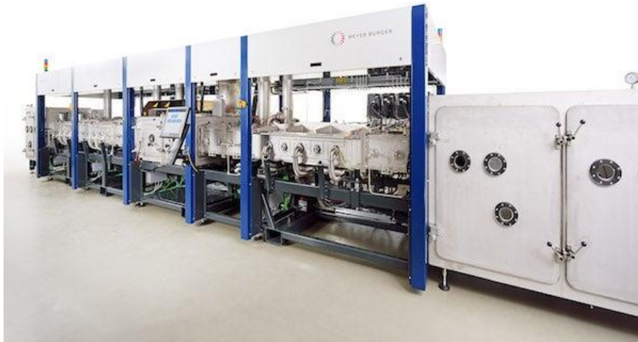
Figure IV.A.23 Photographie de la chaîne de production continue sur tapis roulant d'électrode de nanofil de silicium pour anode de batteries lithium par la start-up Amprius .
