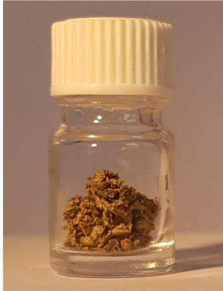
**Figure II.C.3** Aspect final d'une quantité de 10 mg de nanofils isolés par sonication et évaporation. Les nanofils s'agglomèrent sous forme de voiles extrêmement volatiles et sensibles à l'électricité statique.
