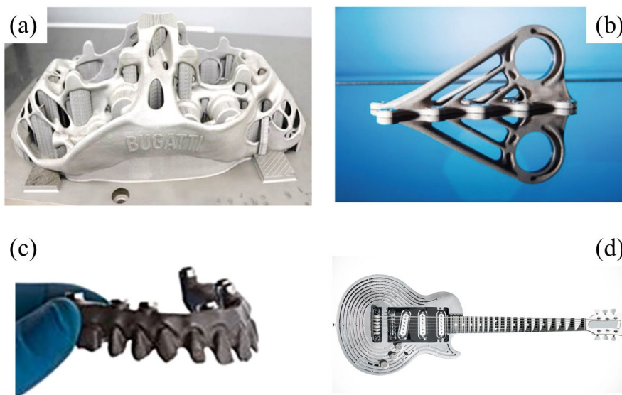
Figure 6 : Exemples de pièces élaborés par FA. (a) Étrier de frein de la Bugatti Chiron en TiAl6V4. (b) Support pour l'A350 en TiAl6V4. (c) Implant dentaire en CoCr. (d) Guitare « incassable » en alliage de Titane. [17]–[20]
