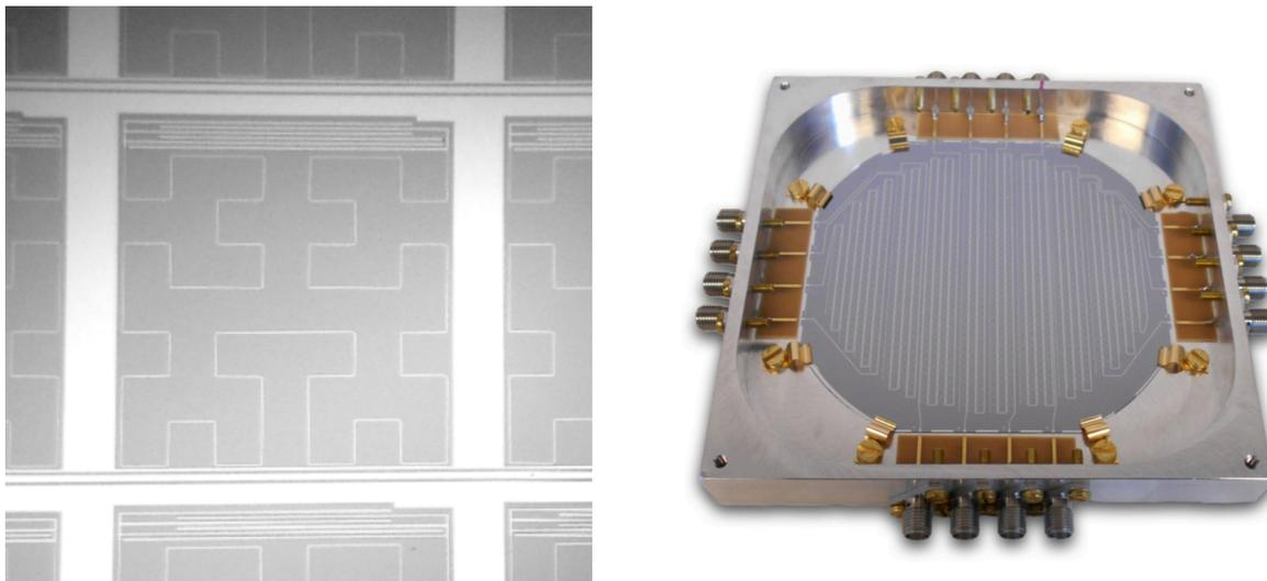
Figure 3.3 : **Gauche** : Image d'un détecteur KID de NIKA, de taille  $2.3 \text{ mm} \times 2.3 \text{ mm}$ . Le méandre inductif du détecteur couvre la plupart de sa surface, tandis que la partie capacitive  $C$  est située dans la partie haut du détecteur. **Droite** : Matrice de KID dans la bande à 260 GHz de NIKA2, comportant 1140 KID et 8 lignes de transmission. Figures extraites de [123].
