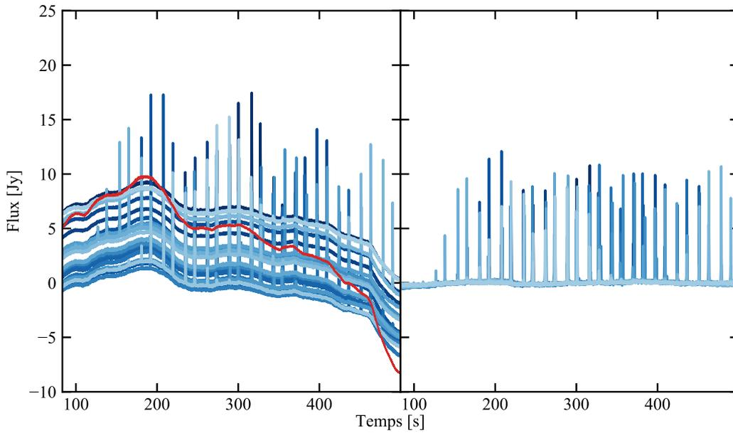
Figure 4.1 : **Gauche** : Données en temps pour 20 détecteurs de la matrice à 150 GHz de NIKA2 lors d’une observation d’Uranus (bleu). Le passage de chaque KID sur la planète est visible par les pics d’émission décalés en temps. Le mode commun estimé sur les TOI de la matrice entière est représenté en rouge.
