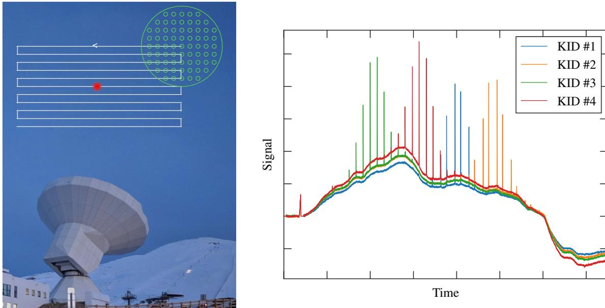
Figure 3.5 : **Gauche** : illustration du mouvement effectué par le télescope dans le ciel (en blanc) lors d'un scan OTF. La matrice de détecteurs est représentée en vert, et la source observée en rouge. **Droite** : représentation des données ordonnées en temps obtenues par scan d'Uranus pour trois KID. La détection de la source se manifeste par un pic de signal détecté.
