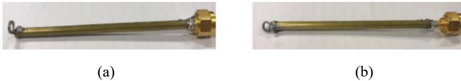
Figure I. 8 : Sonde académiques : (a) Sonde de mesure de la composante normale H_z , (b) Sonde de mesure des composantes tangentielles H_x et H_y .
