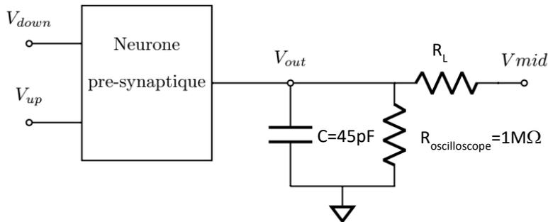
Figure 3.26 : Schéma de mesure du neurone pré-synaptique.
