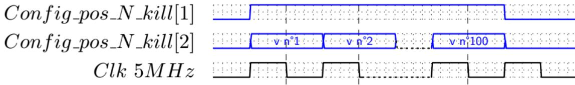
Figure 4.18 : L'inhibition des neurones post-synaptiques est modifiée quand *Config\_post\_N\_kill* [1] passe à 1 et inhibe le neurone  $n^i$  si la valeur  $n^i$  ( $v_n^i$ ) de *Config\_post\_N\_kill* [2] est à 1.
