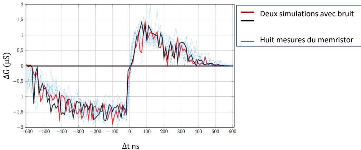
Figure 2.11 : Modèle du memristor avec variabilité de transition qui reproduit 8 mesures de STDP sur un même memristor avec un  $R_{init}$  appartenant à l'intervalle  $[500k\Omega; 650k\Omega]$  pour  $\Delta t < 0$  et  $[9M\Omega; 15M\Omega]$  pour  $\Delta t > 0$ .
