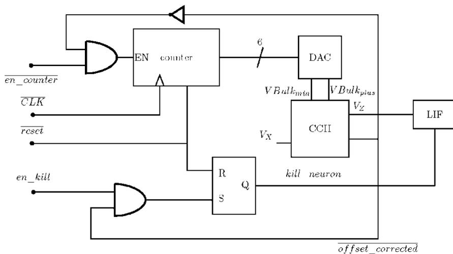
Figure 3.13 : Schéma du fonctionnment du correcteur d'offset pour le CCII.
