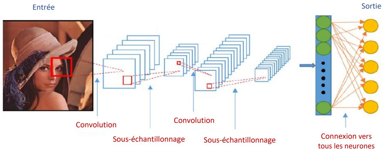
Figure 1.5 Architecture d'un réseau de neurones convolutionnels.
