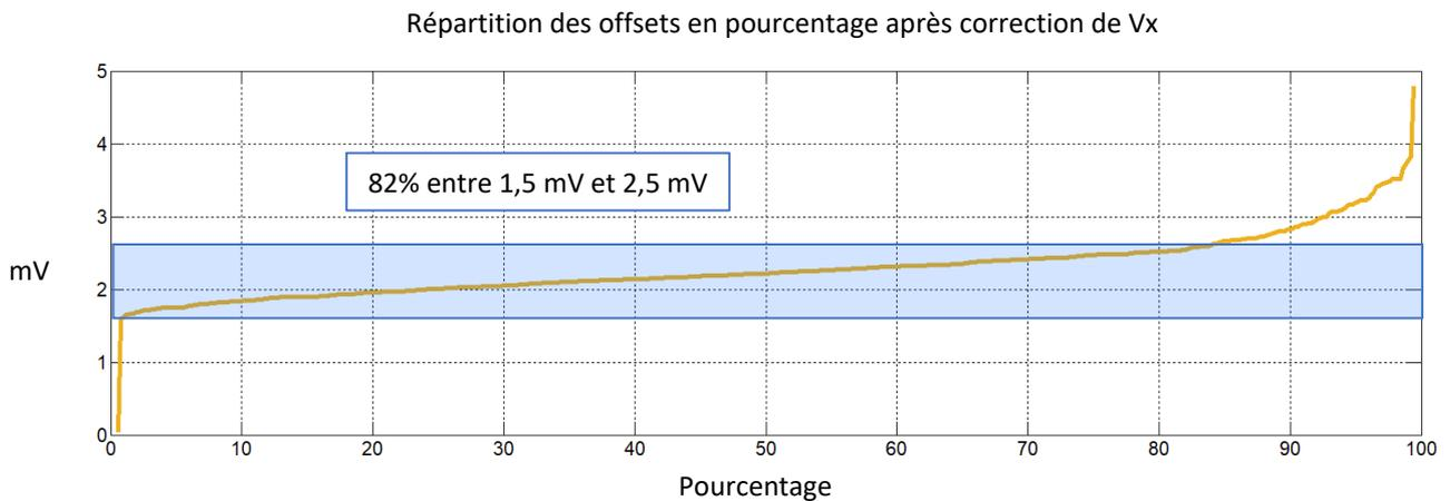
Figure 4.26 : Répartition des offsets du convoyeur de courant sur l'entrée X par rapport à la tension de commande  $V_{mid} = 1,1V$ , après correction sur une simulation Monte-Carlo avec un total de 500 échantillons.
