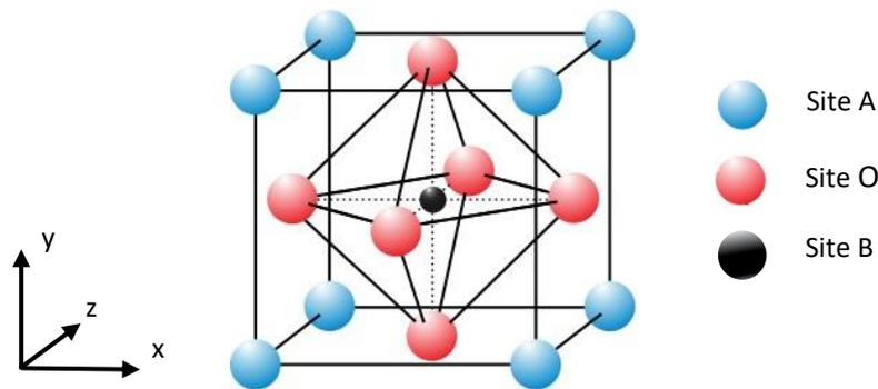
Figure 2.2 : Structure Pérovskite du titane de baryum
