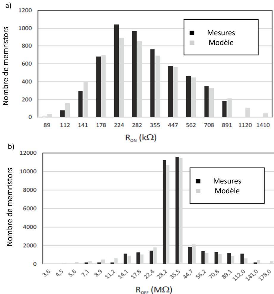
Figure 2.12 : Distribution de  $R_{on}$  et  $R_{off}$  sur les memristors ferroélectriques BTO.
