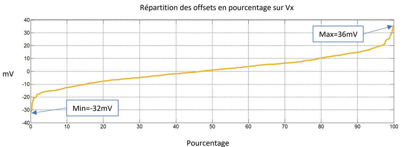
Figure 4.25 : Répartition des offsets du convoyeur de courant sur l'entrée X par rapport à la tension de commande  $V_{mid} = 1,1V$  après une simulation Monte-Carlo avec un total de 500 échantillons et avant correction de l'offset.
