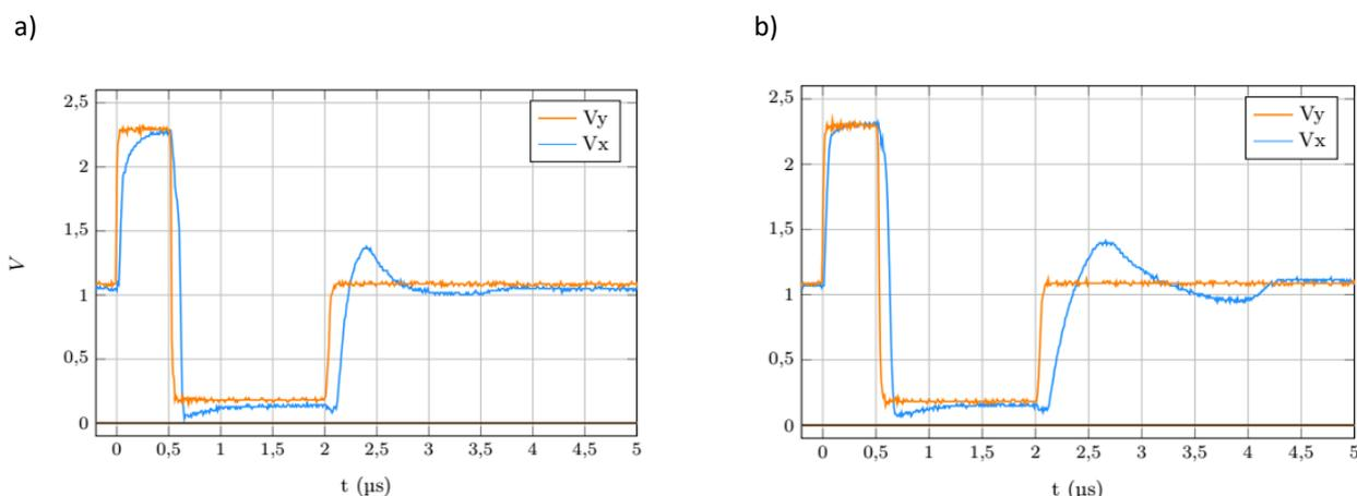
Figure 3.11: Mesures du pulse post du convoyeur de courant. a) Mesure avec une charge de  $1.2k\Omega$  connectée à  $V_{mid}$  et une capacité  $C=45pF$ . b) Mesure sans charge résistive, mais avec une résistance de  $1M\Omega$  de l'oscilloscope et une capacité  $C=45pF$ .
