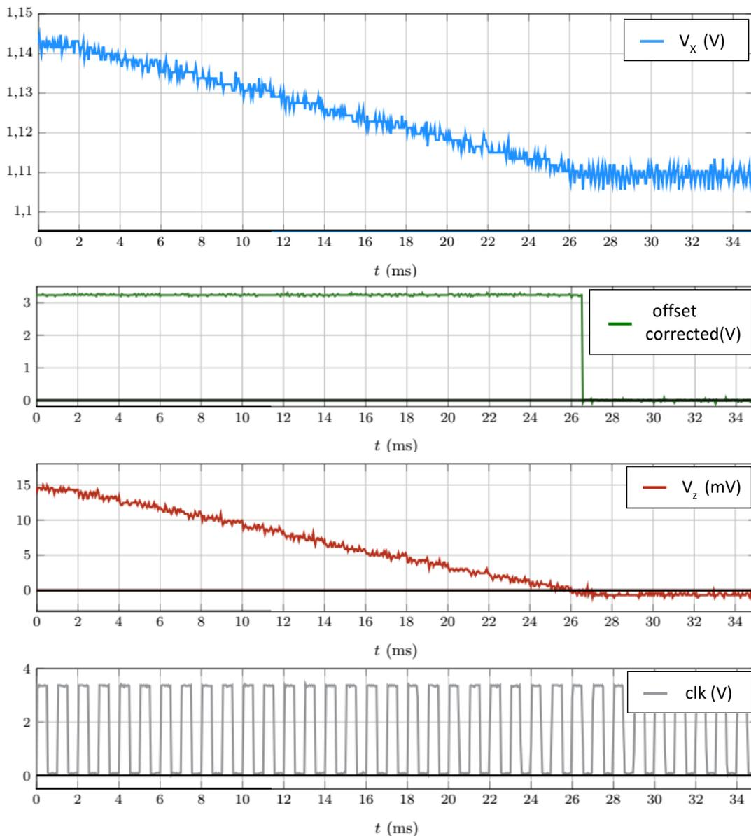
Figure 3.21 : Mesure de la correction d'offset du CCI
