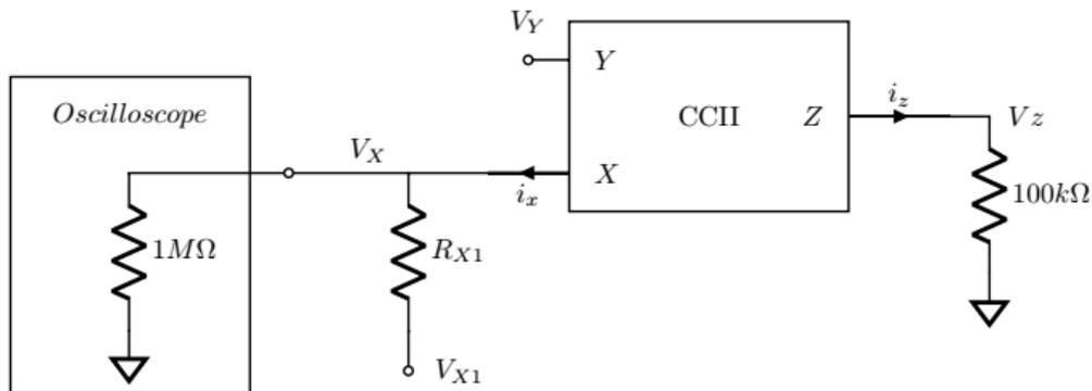
Figure 3.20 : Schéma de la mesure de la correction d'offset du CCH.
