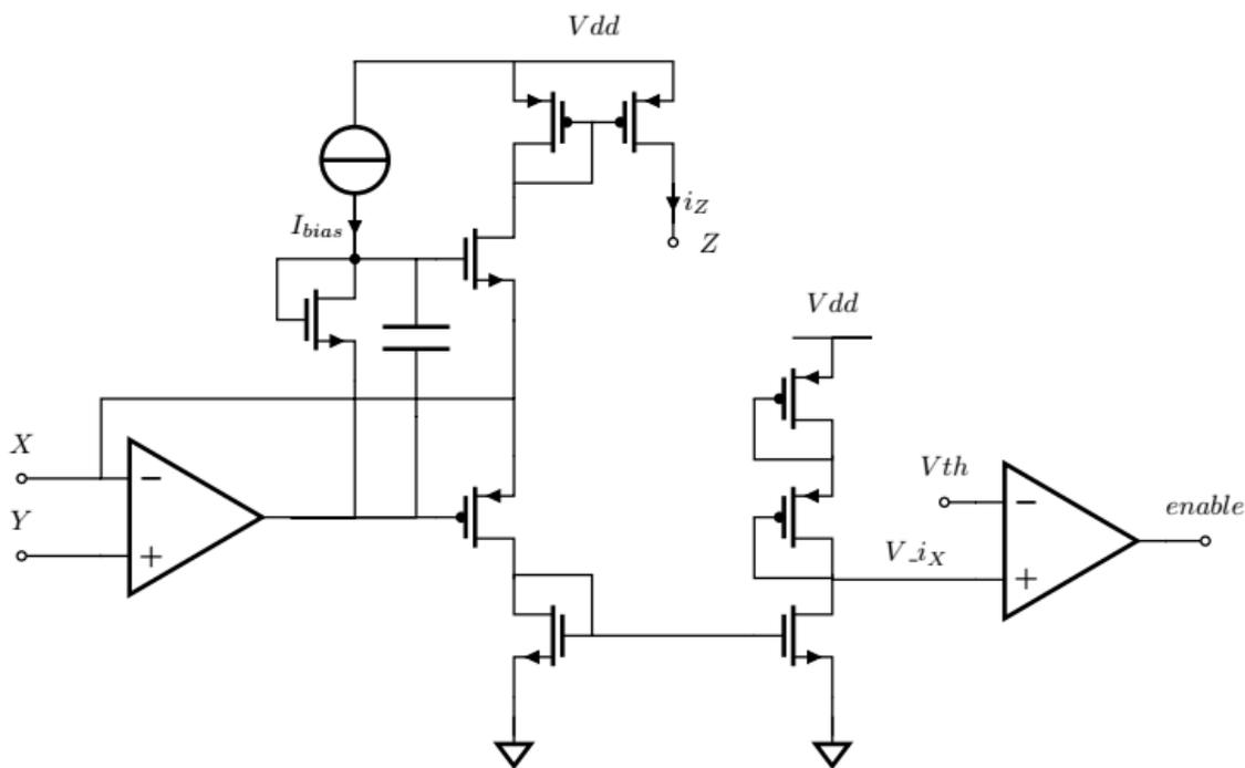
Figure 3.18 : CCII avec détecteur d'offset corrigé.
