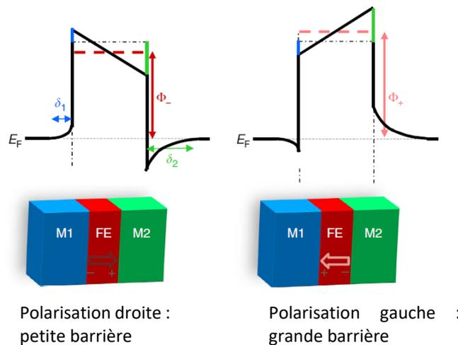
Figure 2.5 : Évolution de la barrière de potentiel au sein du memristor en fonction des deux différentes polarisations.
