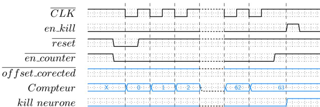
Figure 3.15 : Chronogrammes pour l'offset non corrigé. En en noir les signaux appliqués par le FPGA.
