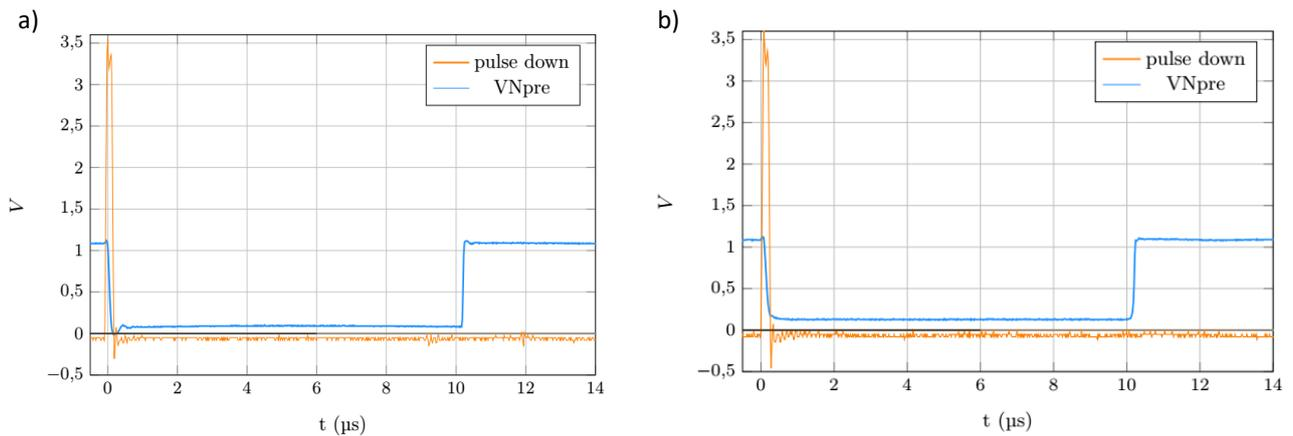
Figure 3.28 : Mesure du pulse « down » du neurone pré-synaptique a) charge  $R_{\text{oscilloscope}} = 1M\Omega$ ,  $C = 45pF$  et  $R_L = \infty$  b) charge  $R_{\text{oscilloscope}} = 1M\Omega$ ,  $C = 45pF$  et  $R_L = 1,2k\Omega$ .
