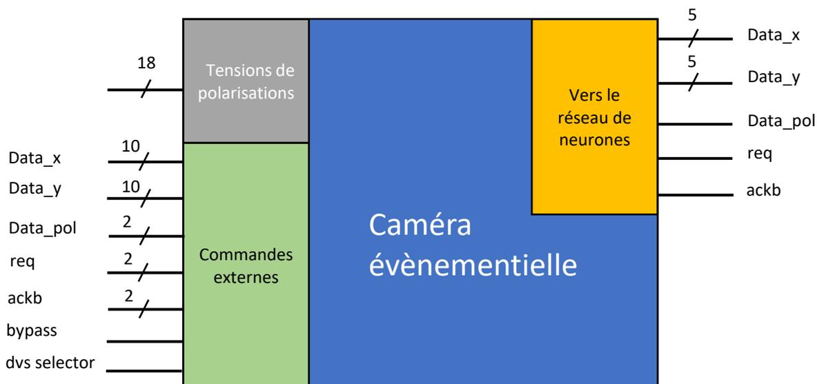
Figure 4.13 : Schéma bloc de la caméra évènementielle.
