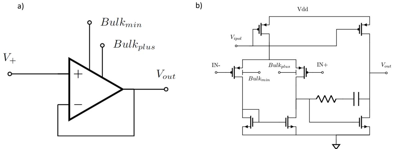
Figure 3.12 : AOP du convoyeur de courant a) schéma bloc, b) schéma électrique interne.
