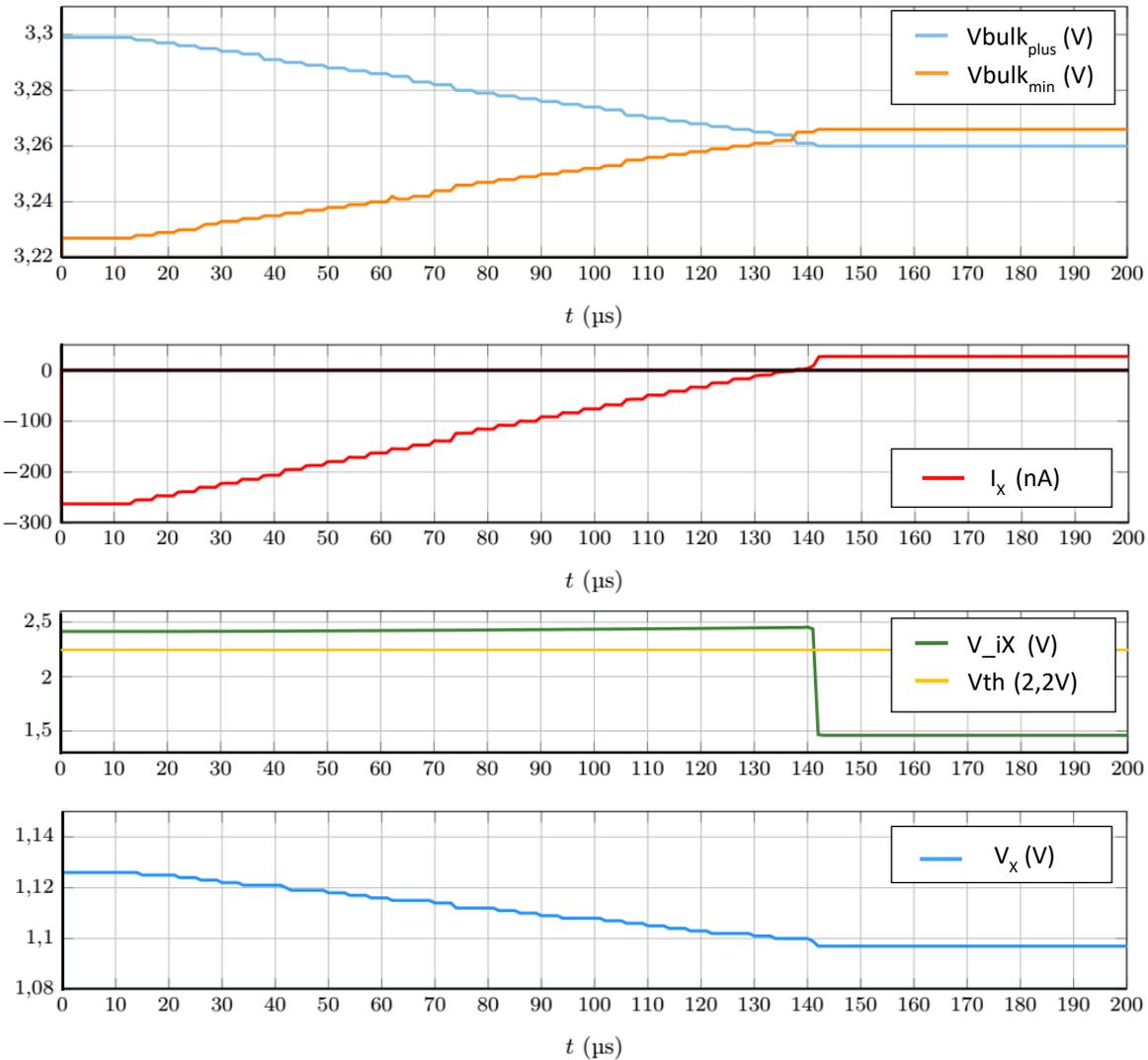
Figure 3.19 : Simulation de la correction d'offset montrant l'évolution des tensions de bulk, du courant  $I_x$ , de la tension  $V_{ix}$  permettant de détecter le changement de sens du courant et la tension  $V_x$ .
