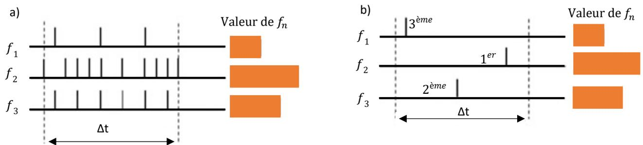
Figure 1.12 : Conversion d'une valeur en évènement : a) fréquentiel, b) : par ordre d'arrivée
