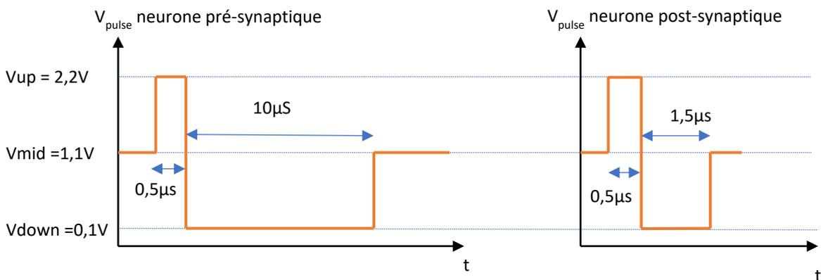
Figure 4.23 : Pulse pré et post-synaptique utilisée pour la simulation.
