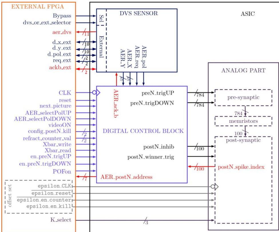
Figure 4.1 : Schéma global de la puce et du FPGA qui la contrôle.
