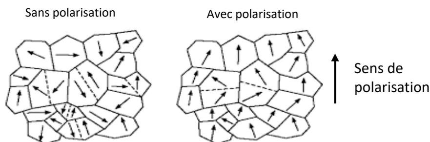
Figure 2.1 : Domaines ferroélectriques avec et sans polarisation
