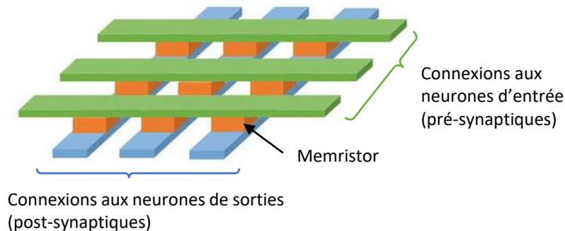
Figure 2.13 : Représentations 3D de la matrice de memristors.
