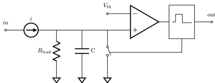
Figure 1.13 : Schéma électrique d'un neurone LIF
