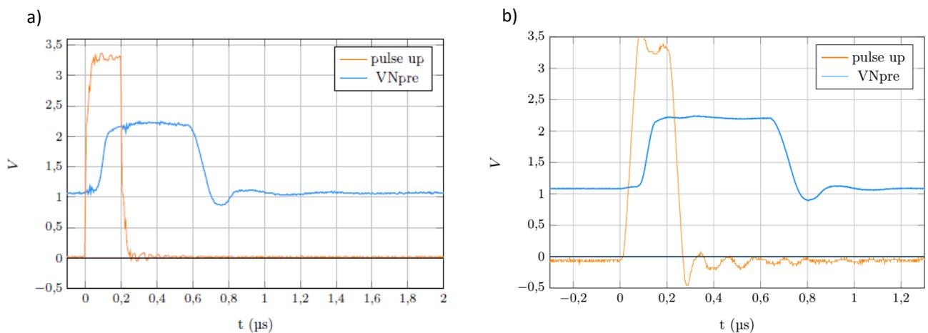
Figure 3.27 : Mesure du pulse « up » du neurone pré-synaptique. a) charge  $R_{oscilloscope}=1M\Omega$ ,  $C=45pF$  et  $R_L = \infty$  b) charge  $R_{oscilloscope}=1M\Omega$ ,  $C=45pF$  et  $R_L = 1,2k\Omega$
