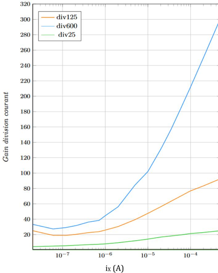
Figure 3.10 : Mesures de la division du courant en fonction du courant  $i_x$
