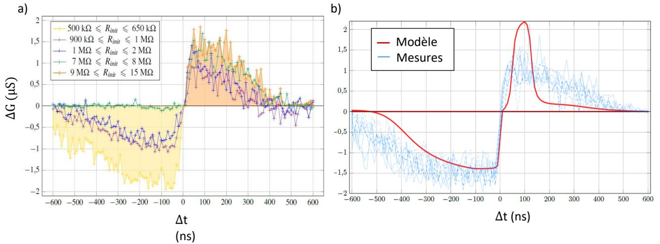
Figure 2.10 : A) Mesure de la variation du poids synaptique du memristor en fonction de  $\Delta t$  et de sa résistance initiale. B) Modèle du memristor qui reproduit 8 mesures de STDP sur un même memristor avec une  $R_{init}$  appartenant à l'intervalle  $[500k\Omega; 650k\Omega]$  pour  $\Delta t < 0ns$  et une  $R_{init}$  appartenant à l'intervalle  $[9M\Omega; 15M\Omega]$  pour  $\Delta t > 0ns$ .
