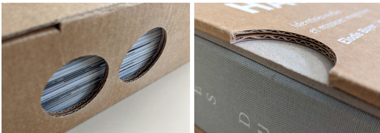
Figura 68 – Detalhes da reentrância e dos orifícios da caixa protetora de Lettres do Havre , com a ondulação do papelão à mostra
