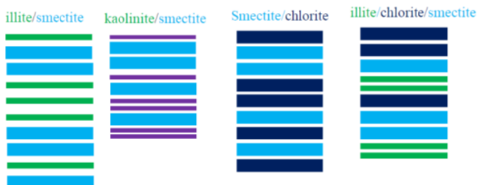
Figure I-7 : Différentes possibilités d'interstratification [40]
