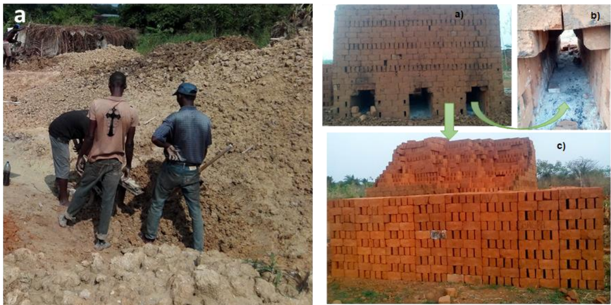
Figure II-5: Pressage et cuisson artisanale des briques
