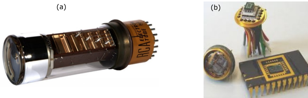
FIGURE 2.6 – Tube photomultiplicateur (a) et photodiode à avalanche (b) utilisés dans le régime de comptage de photon. Sources : réf. [65] pour la figure 2.6(a) et réf. [66] pour la figure 2.6(b).
