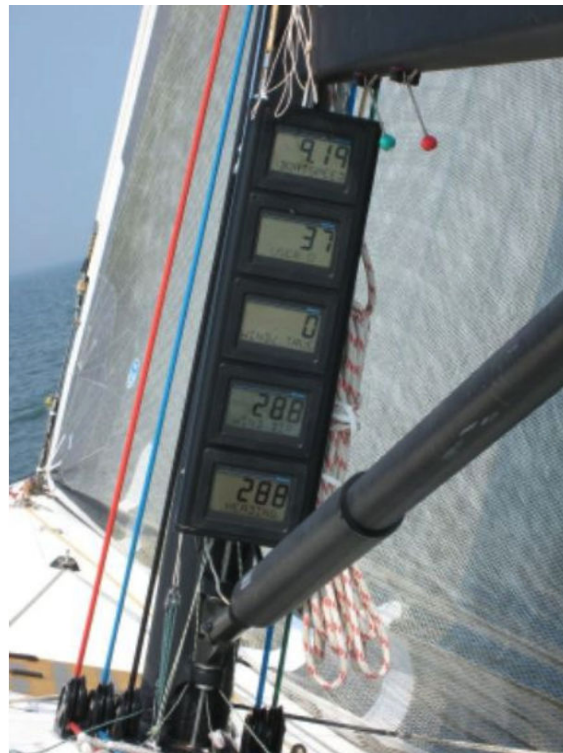
FIGURE 1.17 – Exemple de gradient et shear très prononcés. Les instruments de ce bateau bien calibré, indiquent qu’il remonte droit dans l’axe du vent réel (Le cadran du milieu affiche \beta_T = 0 et le cap du bateau et la direction du vent réel affichés sur les deux cadrans du bas sont identiques. Le bas des voiles est rempli de vent, tandis qu’en altitude, la combinaison du shear et du gradient amène le vent apparent et réel dans l’axe. Crédit : Ockam MD .
