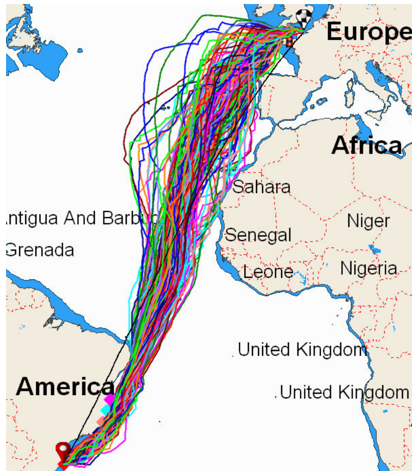
FIGURE 2.28 – Exemple de 150 routages statistiques pour le parcours de la transat Jacques Vabre 2015 concernant un 60'Imoca. Calculs basés sur les données météorologiques des 10 dernières années avec un balayage de la date de départ à \pm 7 jours.
