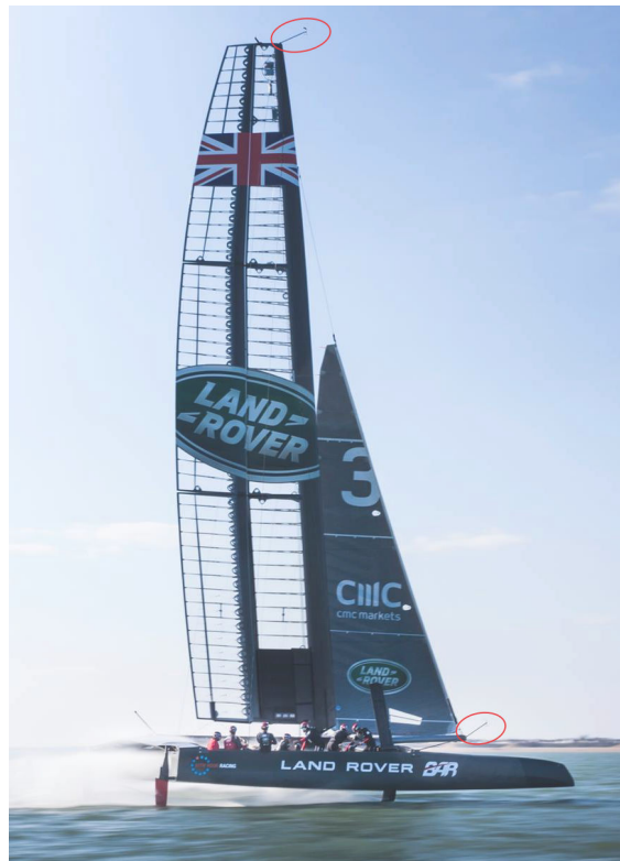
FIGURE 1.12 – Sur les AC50, bateaux de la Coupe de l’America qui vont plus vite que le vent réel au portant, un aérien a été rajouté à l’avant au niveau du pont. Le capteur n’est pas masqué puisque le vent apparent vient toujours de devant sur ce type de bateaux.
