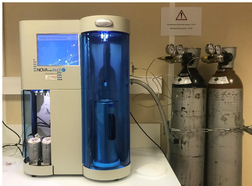
Figure D. 1 - Dispositif de mesure NOVA touch pour la détermination de la surface spécifique et de la distribution de la taille des pores.
